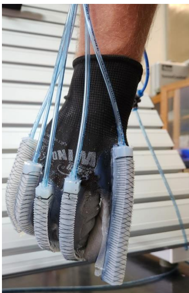
Slika 8.4. Ispitivanje rukavice: fleksija 4 prsta (bez palca)
