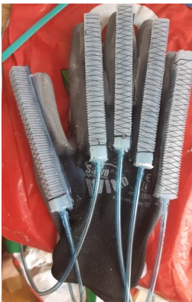
Slika 8.2. Konačni izgled prototipa rukavice za rehabilitaciju šake
