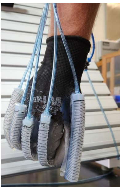
Slika 8.4. Ispitivanje rukavice: fleksija 4 prsta (bez palca)
