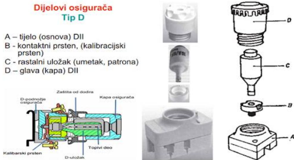
Slika 3.4. Dijelovi osigurača D tipa [4]
