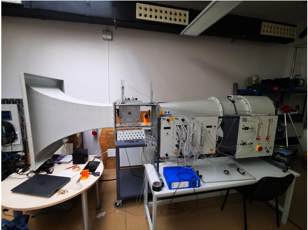
Slika 32: Aerotunel AF1300S korišten za testiranje modela lopatica
