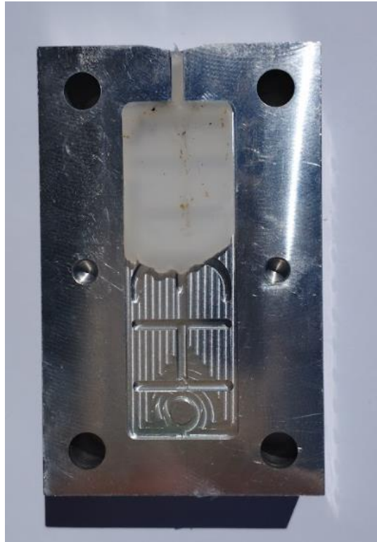
Slika 6.3. Izgled nakon otvaranja kalupa (TEST 4)
