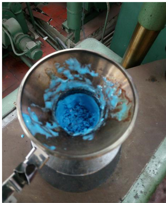
Slika 3.2. Nerastaljeni polimer unutar komore
