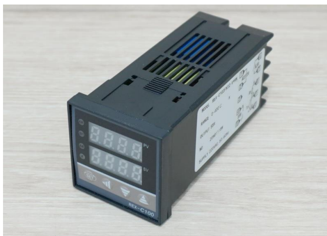
Slika 3.29. Uređaj za regulaciju temperature REX-C100
