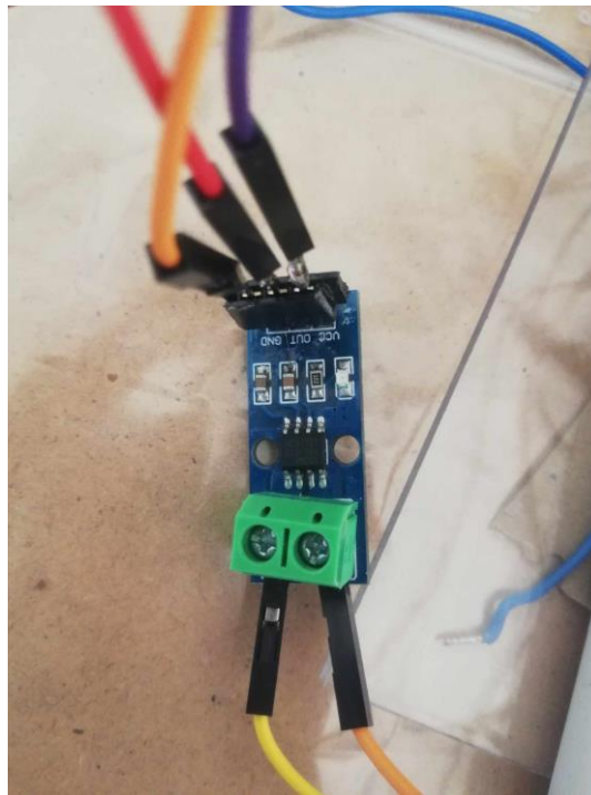
Slika 5.9 Senzor struje ACS712
