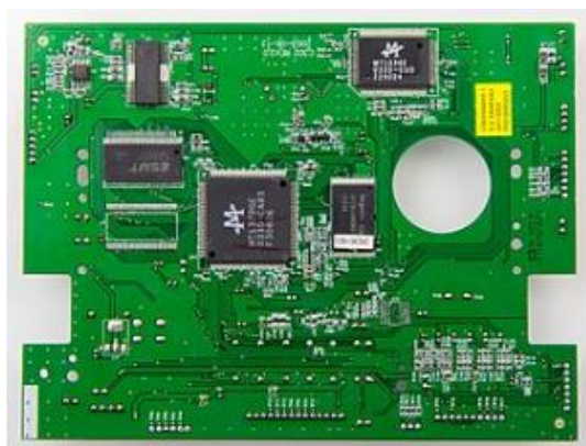
Slika 4.1 Tiskana pločica sa SMD komponentama
