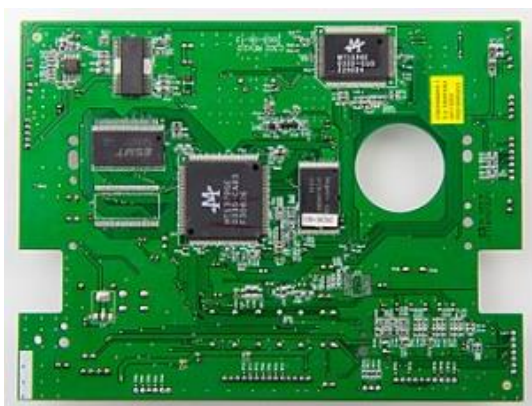
Slika 4.1 Tiskana pločica sa SMD komponentama
