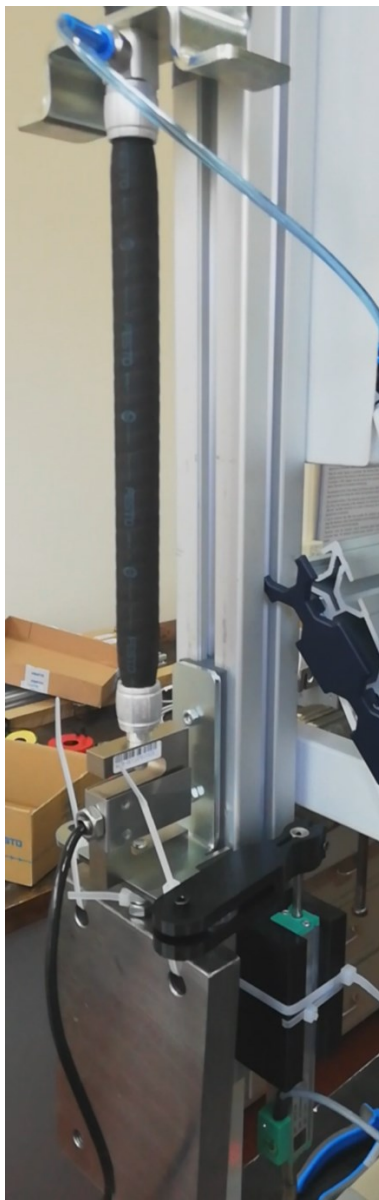
Dodatak A2. Eksperimentalni postav u vertikalnom položaju s utegom
