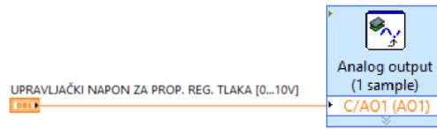
Slika 5.25. Port za generiranje upravljačkog napona proporcionalnog regulatora tlaka
