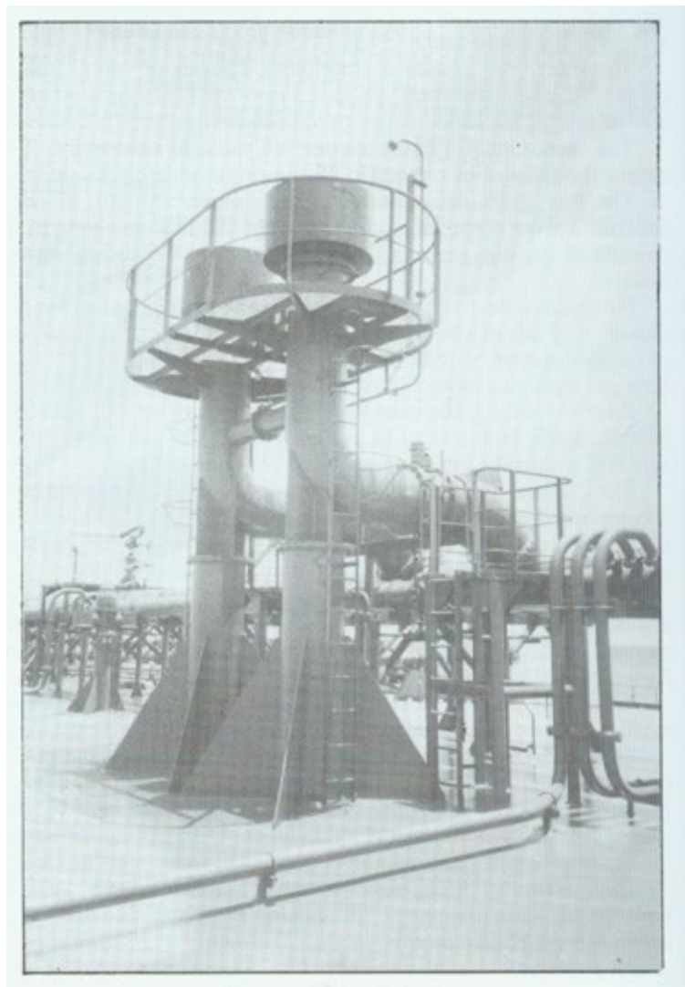
Slika 3.10. Odušivanje tanka na brodu Meridian Lion [1]
