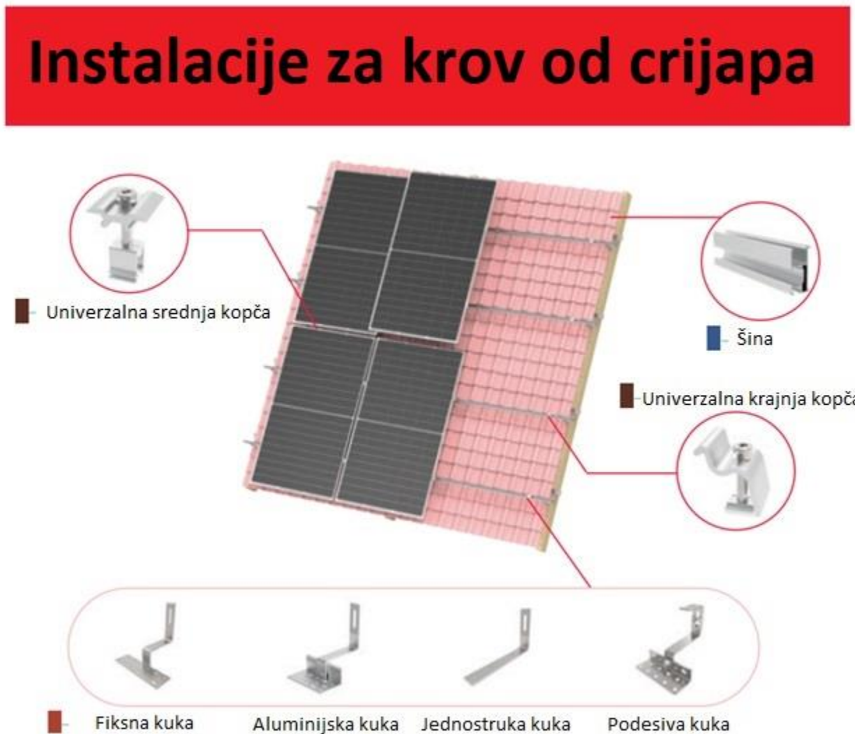
Slika 10.5. Konstrukcija nosača iz kataloga [34]
