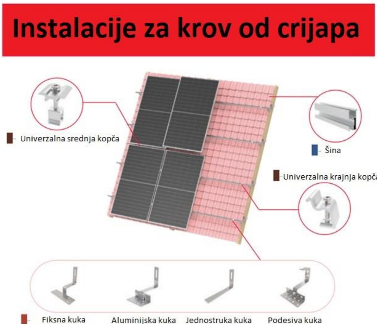
Slika 10.5. Konstrukcija nosača iz kataloga [34]
