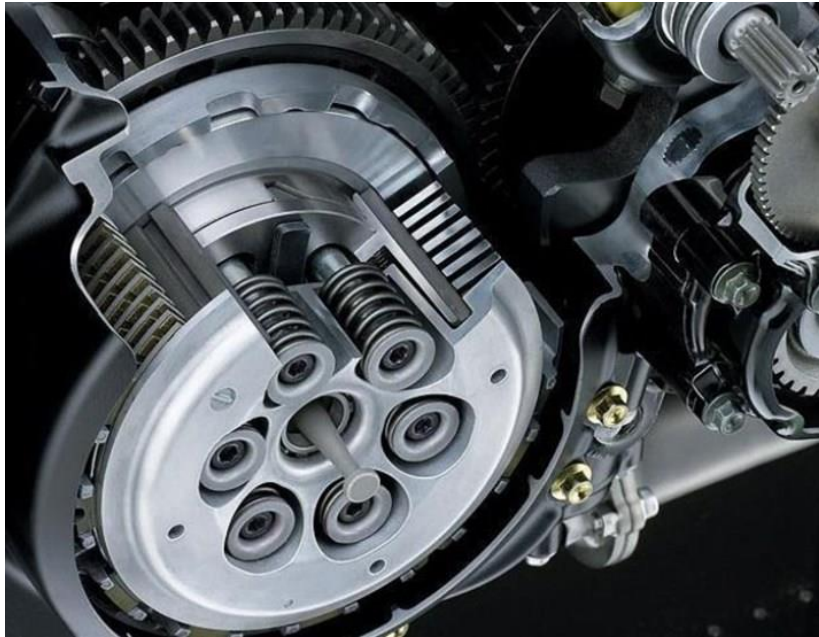
Slika 1.2. Prikaz sklopa motociklističke spojke [2]
