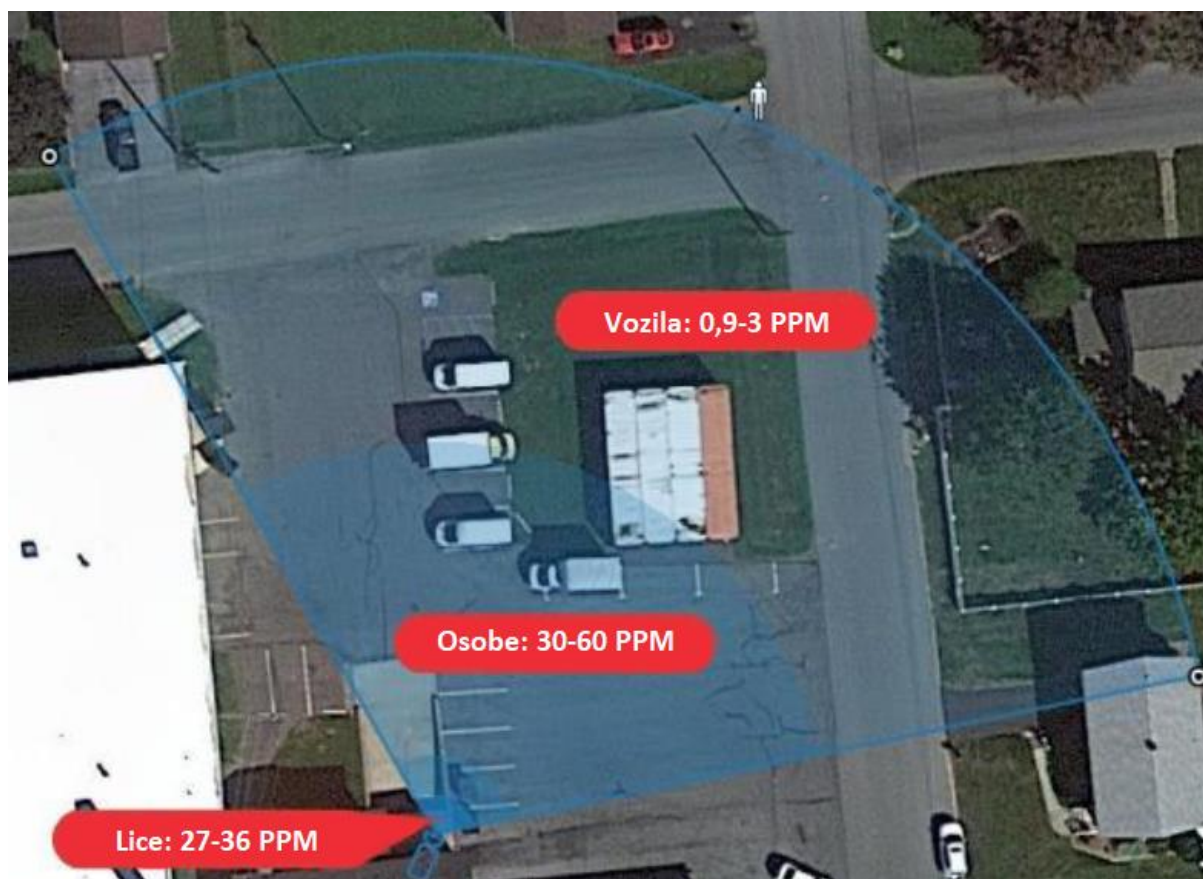
Slika 5.3. Detekcija objekta ovisno o širini scene [66]
