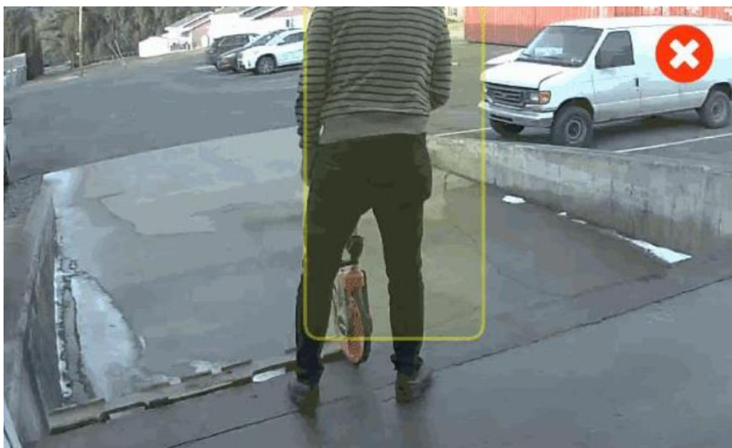
Slika 5.5. Nepostojanje detekcije pri djelomičnom prikazu osobe [68]
