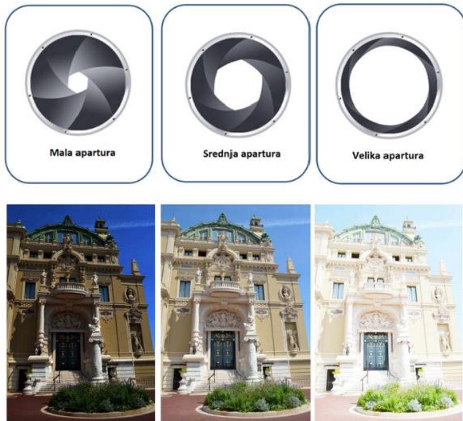
Slika 4.4. Ovisnost kvalitete slike o aperturi [8]
