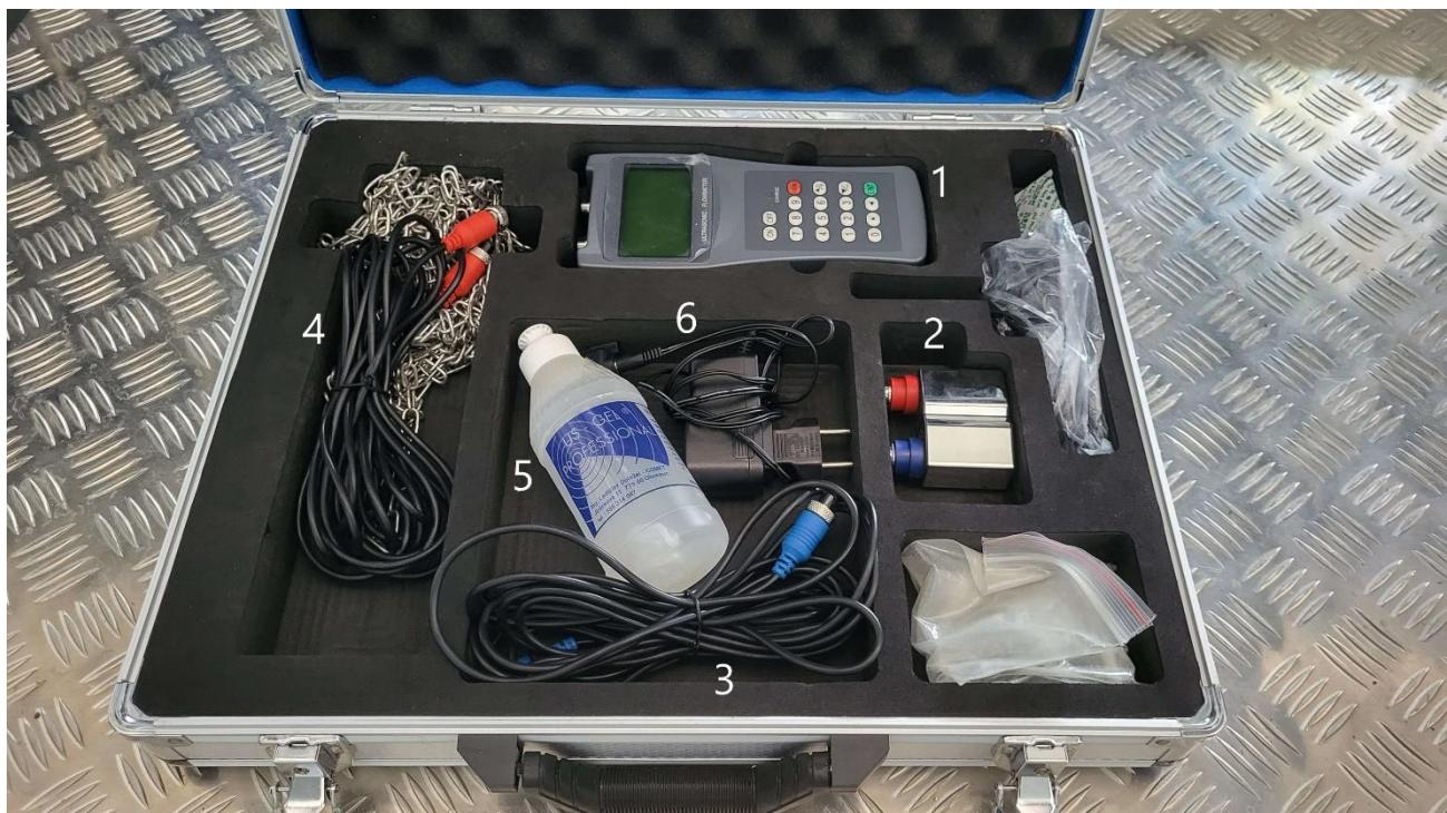
Slika 5.4. Set pribora ultrazvučnog protokomjera FDT-21 (izvor: autor)
