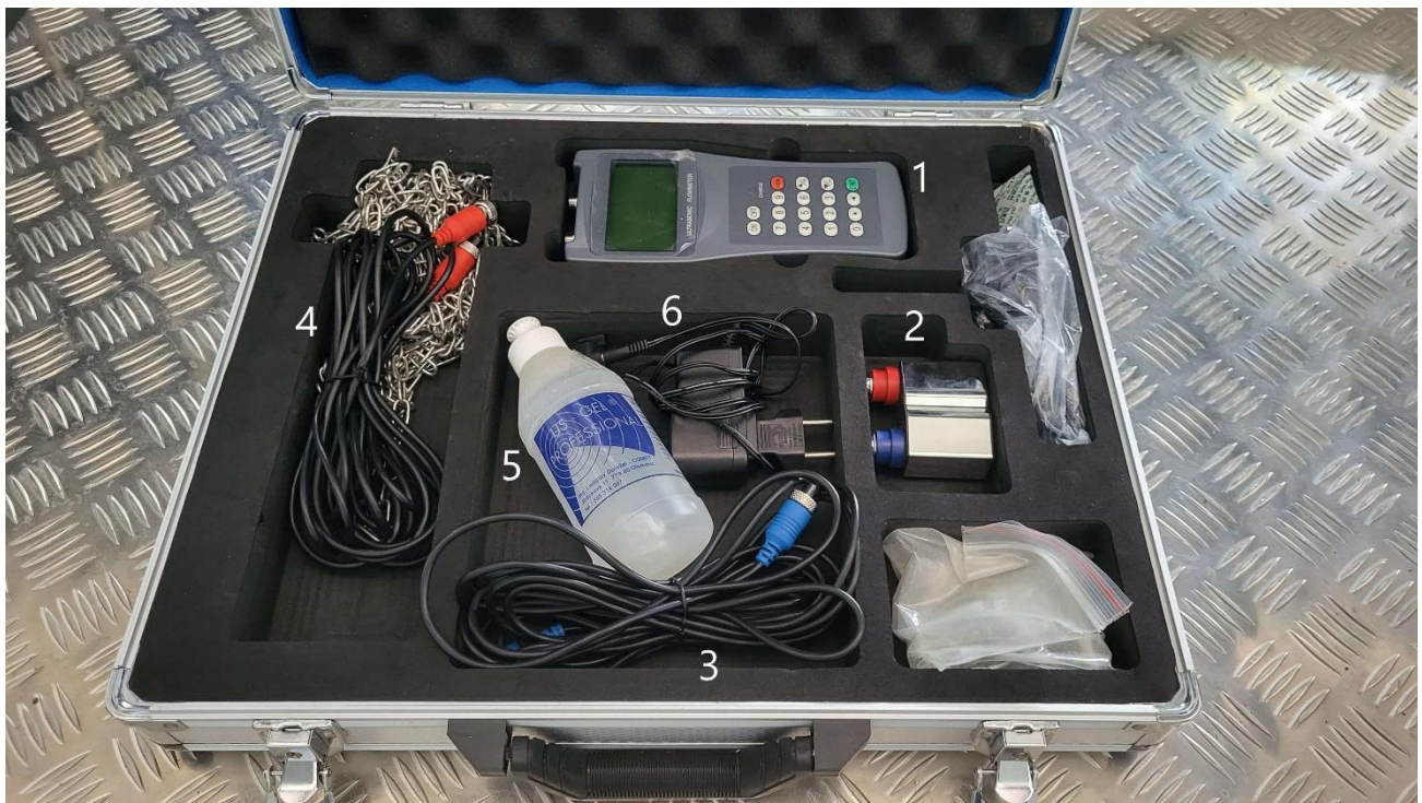
Slika 5.4. Set pribora ultrazvučnog protokomjera FDT-21 (izvor: autor)
