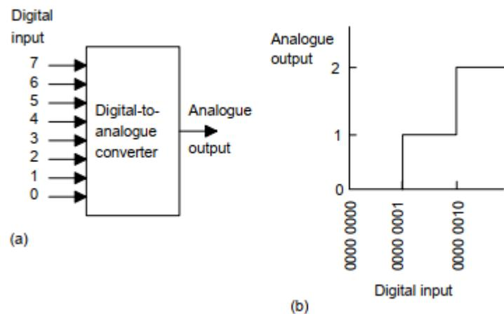
Slika 12 Prikaz osnovne rada D/A pretvornika [4]
