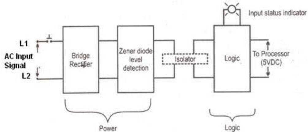
Slika 4 Blok shema načina rada digitalnog ulaza PLC-a [6]
