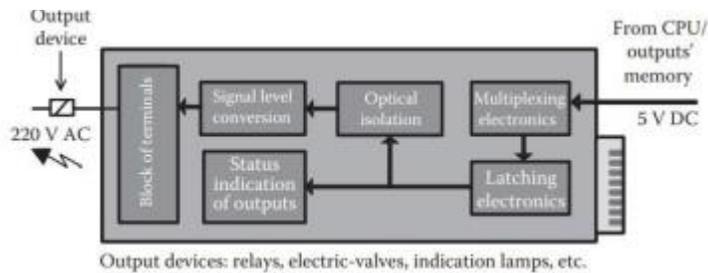
Slika 8 Blok dijagram rada digitalnog izlaznog modula [7]
