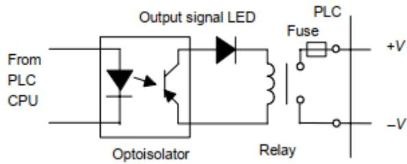
Slika 9 Električna shema relejnog izlaza PLC-a [4]
