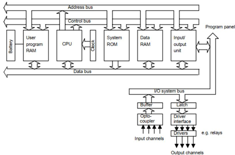
Slika 15 Blok dijagram unutarnjih komponenti PLC-a [4]
