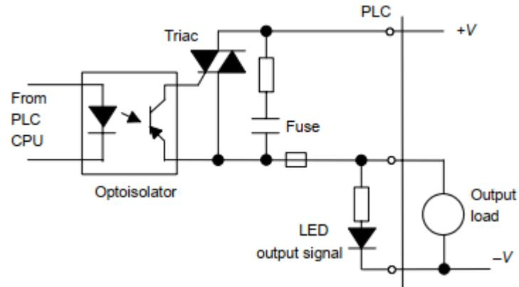
Slika 11 Električna shema izlaznog kruga PLC-a izvedenog trijakom [4]
