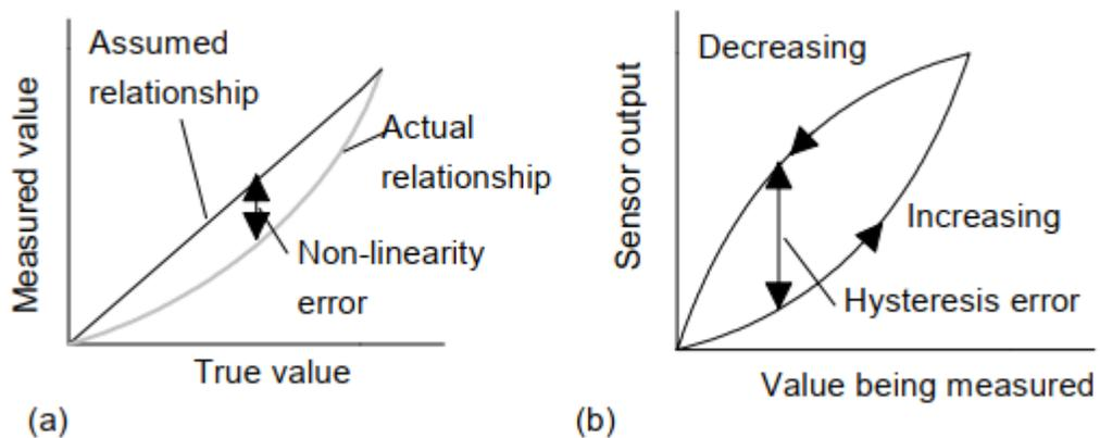
Slika 7 Izvori pogrešaka kod analognih senzora [4]
