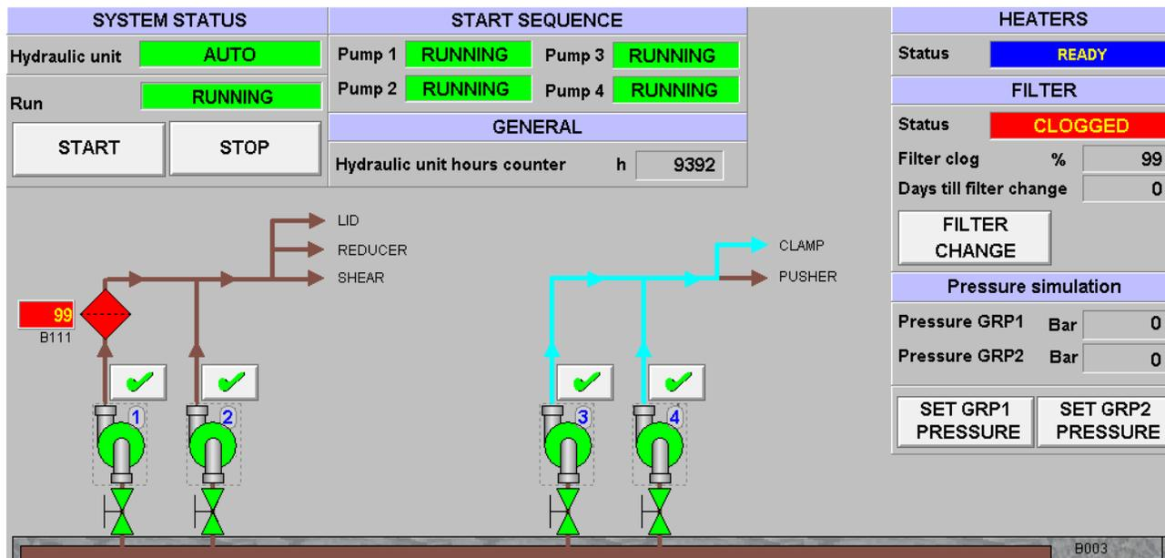
Slika 60 Stranica hidraulike tijekom gibanja cilindra Clamp
