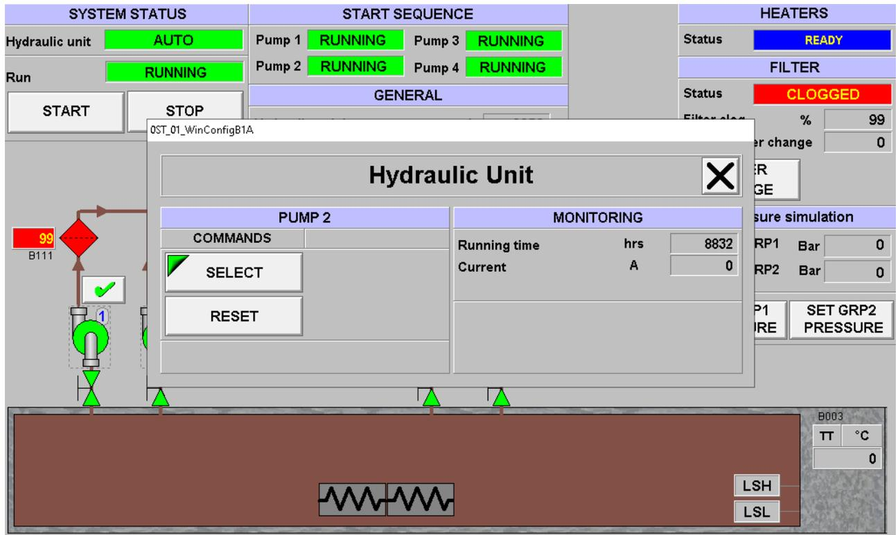
Slika 55 Stranica hidraulike s skočnim prozorom pumpe
