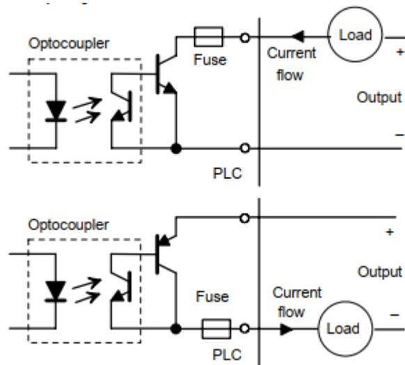
Slika 10 Električna shema tranzistorskog izlaza PLC-a [4]
