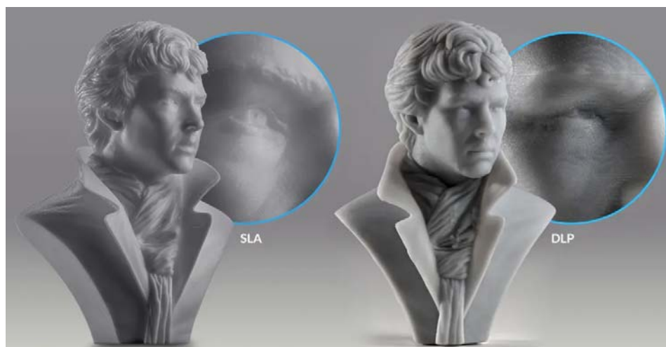
Slika 2.13 SLA i DLP kvaliteta površine
