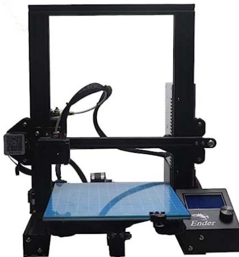
Slika 3.4 Staklena podloga za ispis
