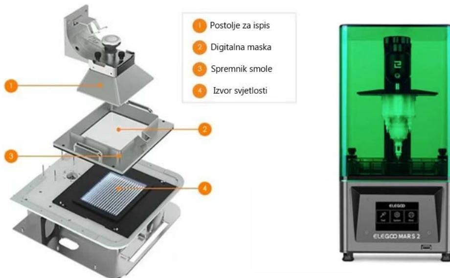
Slika 2.11 Dijelovi MSLA
