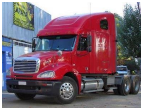
Slika 1.5 - Primjer kamiona tegljača sa 3 osovine; [4]
