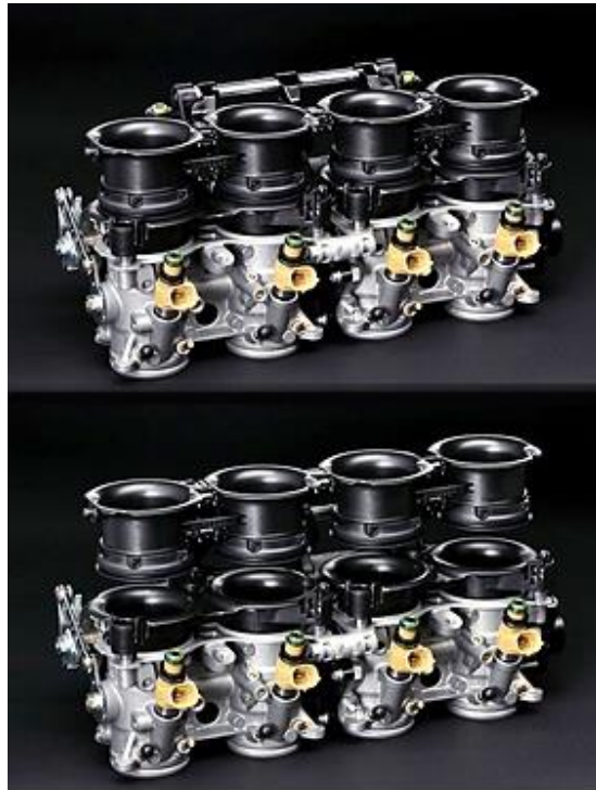
Slika 3.5. Usisni sustav s trubicama promjenjive duljine [10]
