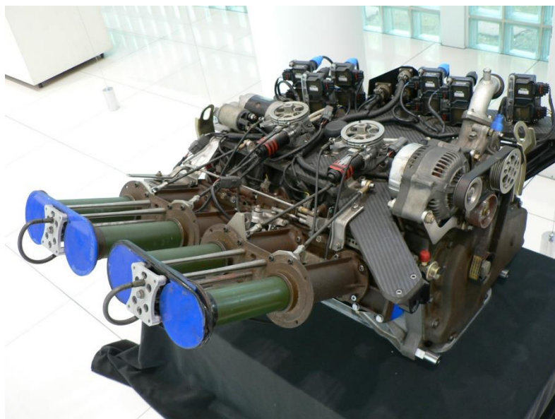
Slika 3.6. Teleskopski sustav promjenjive duljine usisnih vodova. [8]
