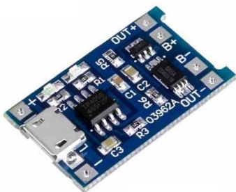
Slika 4.2. Izgled modula TP4056
