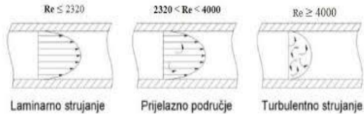
Slika 2.8 Prikaz laminarnog, prijelaznog i turbulentnog strujanja[7]
