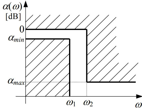
*Slika 2.2. Specifikacije amplitudno frekvencijske karakteristike NP filtra [2]*
