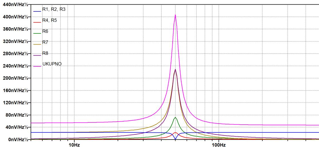
Slika 5.10. Grafički prikaz simulacije spektralne gustoće napona šuma za  $f_0 = 50 \text{ Hz}$
