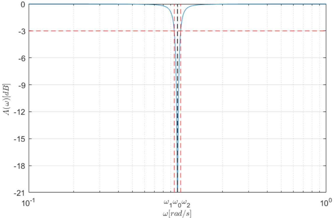
Slika 3.3. Grafički prikaz amplitudno frekvencijske karakteristike  $A(\omega)$
