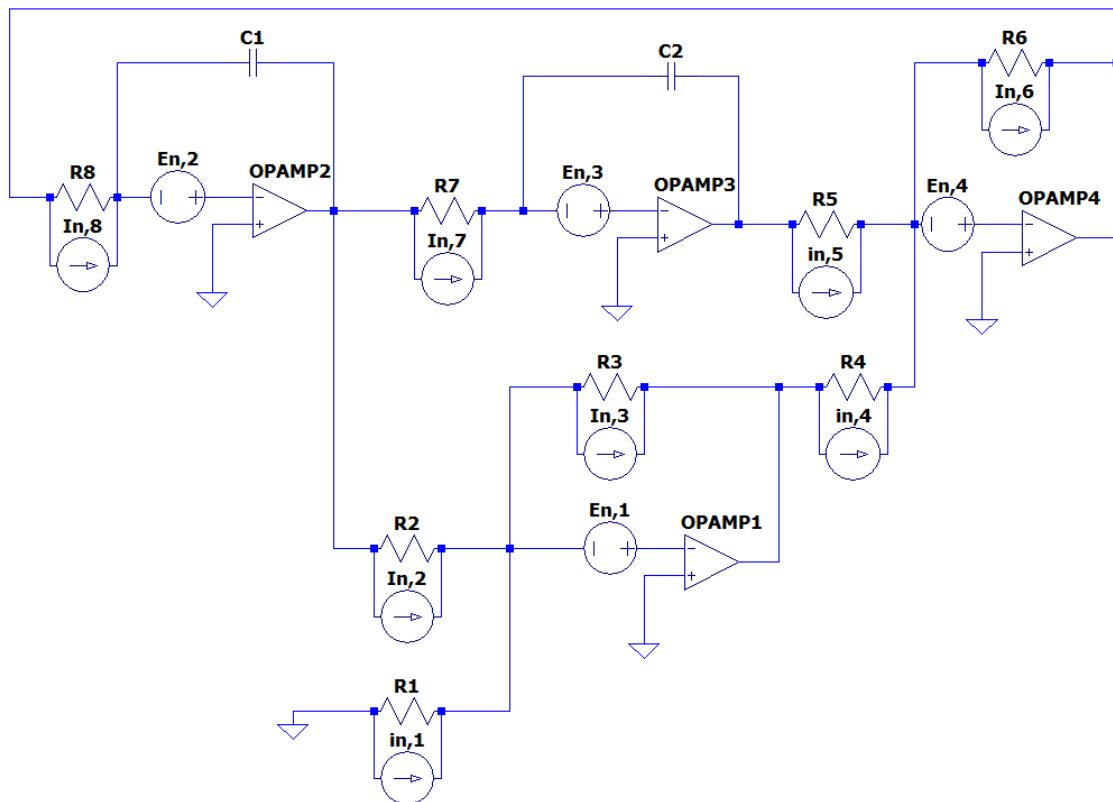
Slika 4.14. Shema električnog šuma unutar željenog filtra
