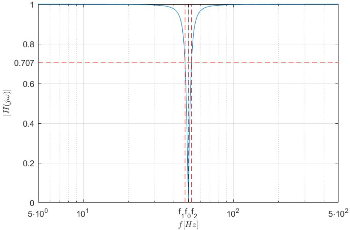
Slika 4.1. Grafički prikaz amplitudno frekvencijske karakteristike  $|H(j\omega)|$  za  $f_0 = 50$  Hz
