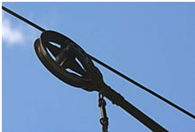
Slika 3.4. Primjer kontaktnog kotača na oduzimaču struje.
