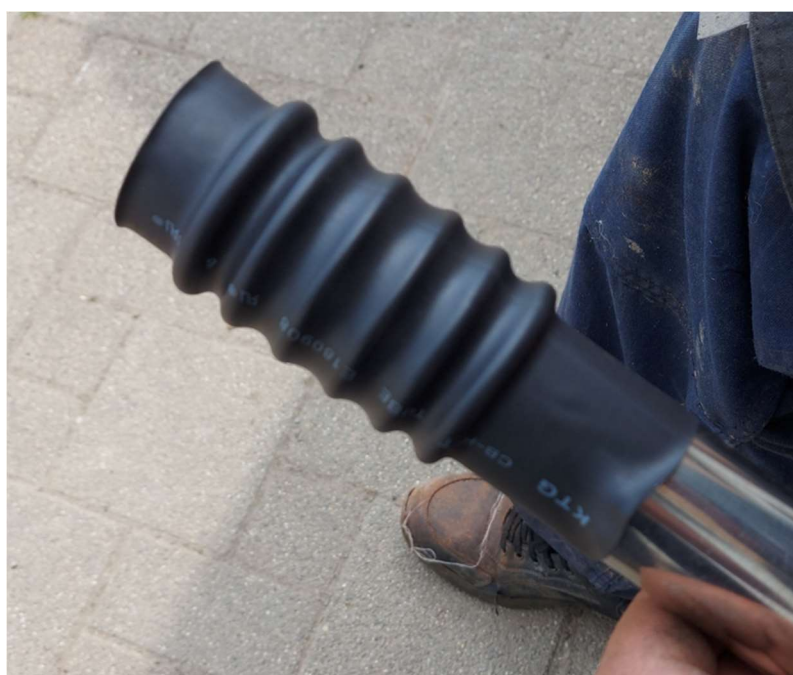
Slika 2.5. Termo-deformabilna polimerna cijev na kalupu nakon zagrijavanja
