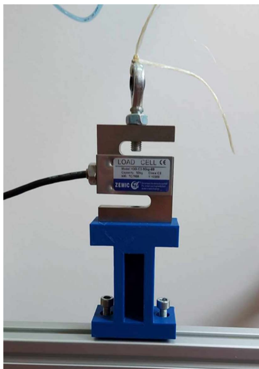
Slika 3.8. Senzor sile Zemic H3G-C3-50kg-6B
