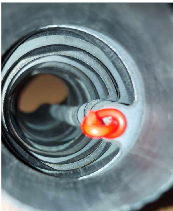
Slika 2.20. Unutrašnjost mišića s kutnim pomakom
