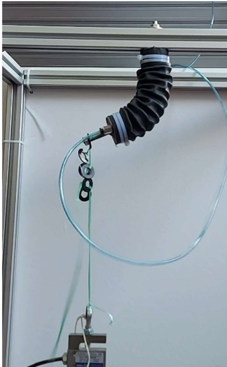
Slika 4.19. Mišić 3 povezan na senzor sile
