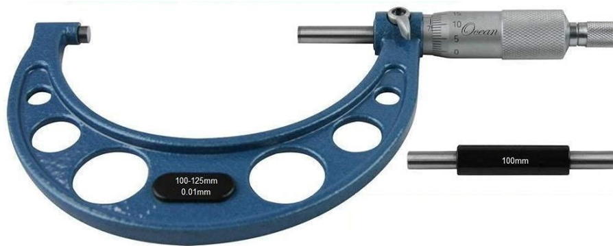
Slika 5.25 Mikrometar Ocean 100-125 mm
