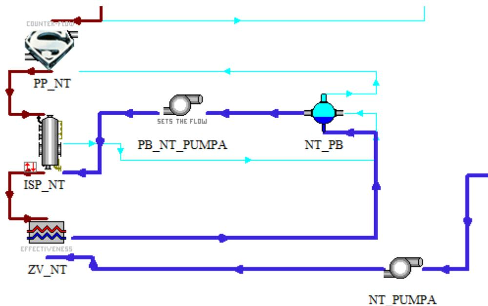
Slika 5.16. Shema niskotlačnog utilizatora u programu TRNSYS
