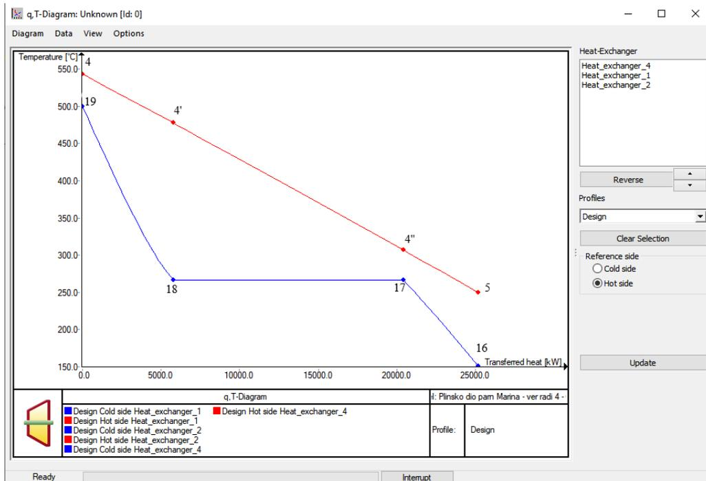
Slika 4.14. T-Q dijagram za visokotlačni utilizator
