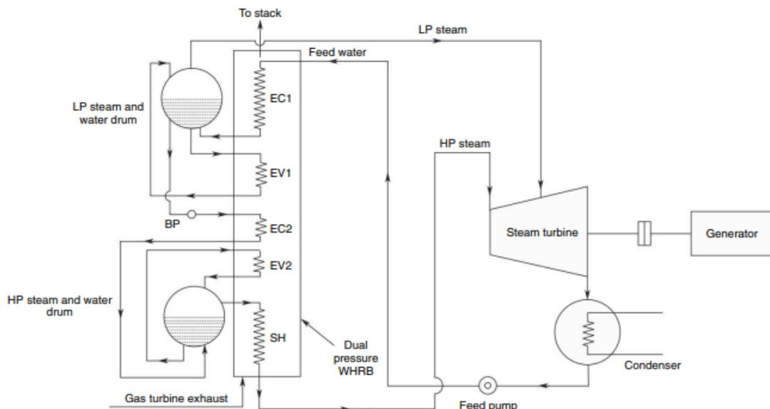
Slika 2.6. Shema parne elektrane s dvotlačnim utilizatorom [3]
