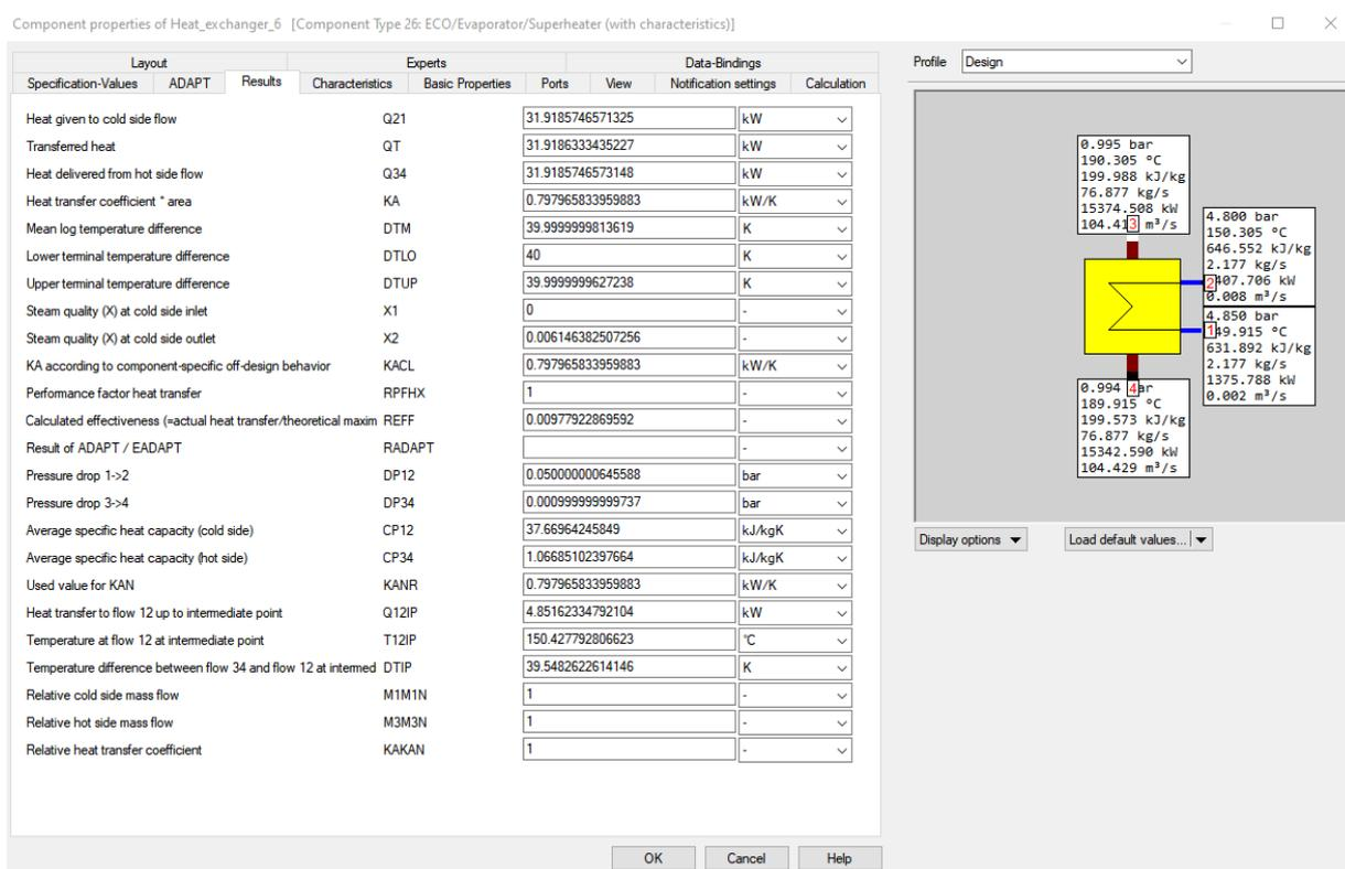
Slika 4.16. Komponenta 26 – niskotlačni zagrijač vode
