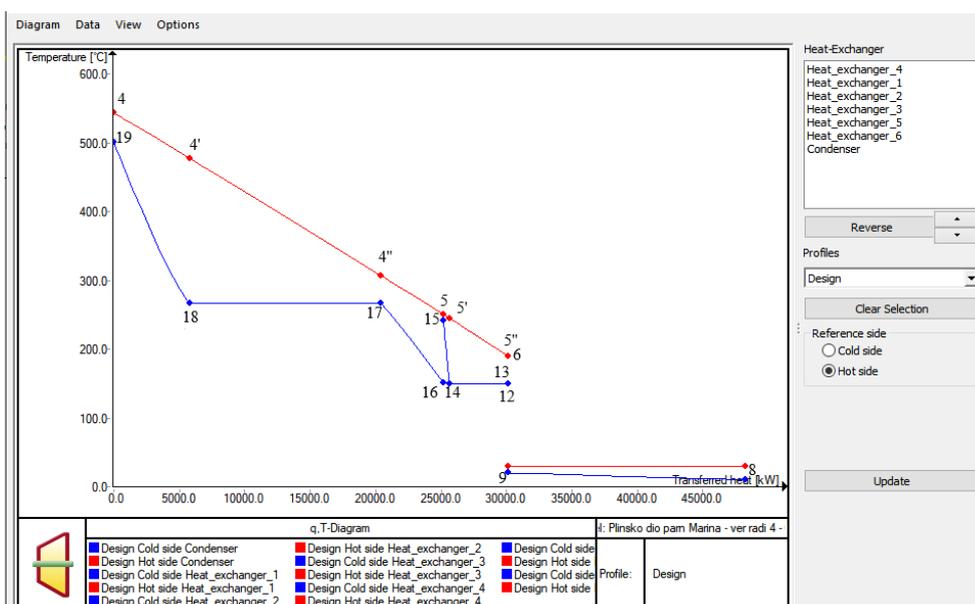
Slika 4.20. T-Q dijagram visokotlačnog i niskotlačnog utilizatora
