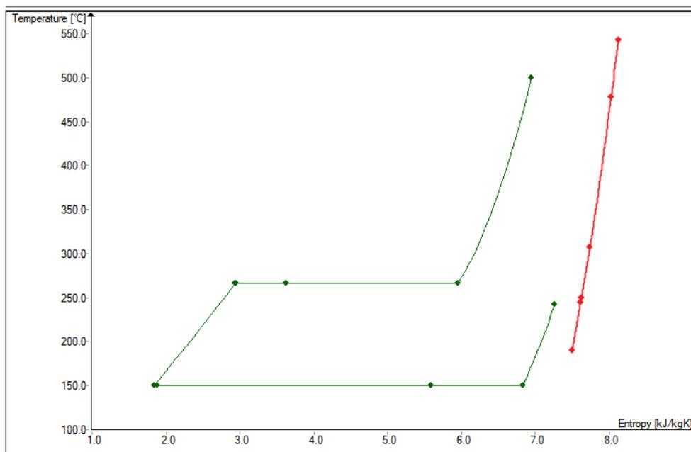
Slika 4.21. T-s dijagram za dvotlačni utilizator
