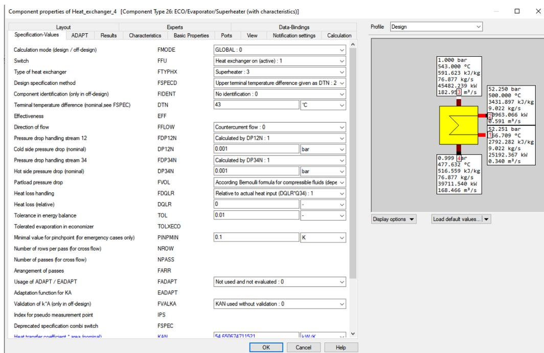
Slika 4.12. Komponenta 26 – visokotlačni pregrijač pare
