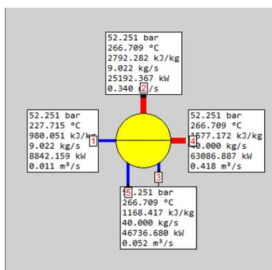
Slika 4.10. Komponenta 20 – visokotlačni parni bubanj
