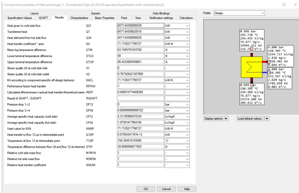
Slika 4.17. Komponenta 26 – niskotlačni isparivač
