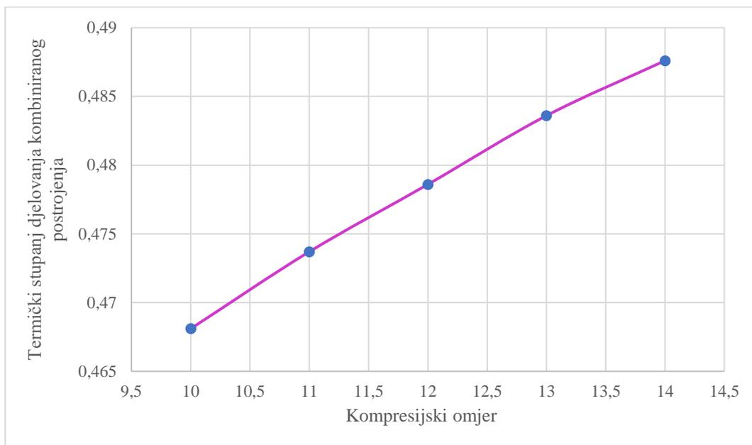
Slika 6.7. Dijagram ovisnosti termičkog stupanja djelovanja kombiniranog postrojenja o kompresijskom omjeru
