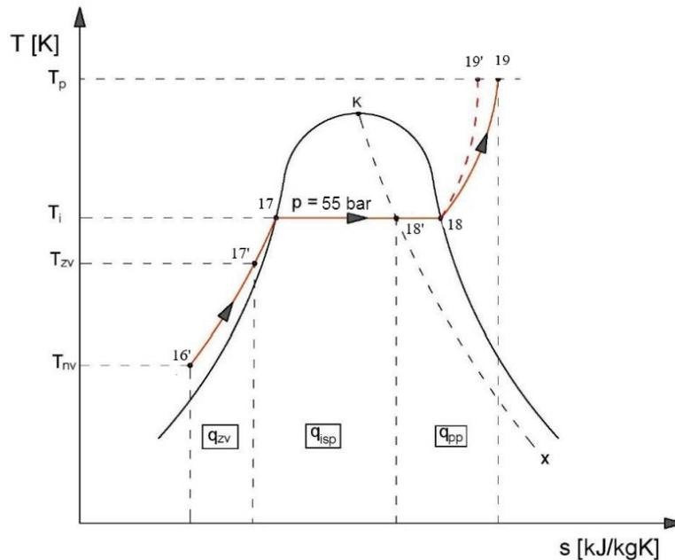
Slika 3.6. T-s dijagram promjene stanja u visokotlačnom utilizatoru
