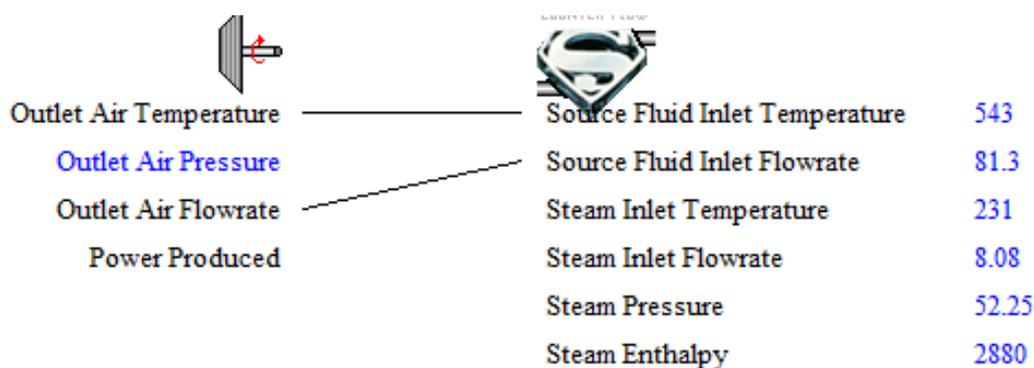
Slika 5.10. Prikaz spajanja ulaznih podataka dimnih plinova u pregrijač pare
