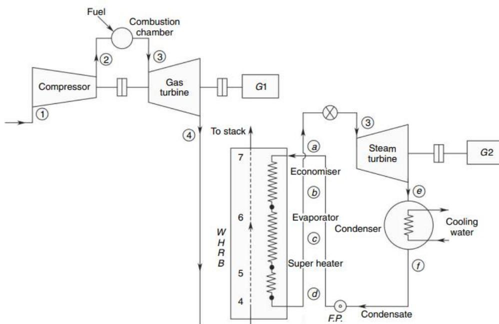
Slika 2.5. Kombinirana plinsko - parna termoelektrana s jednostupanjskim utilizatorom [3]
