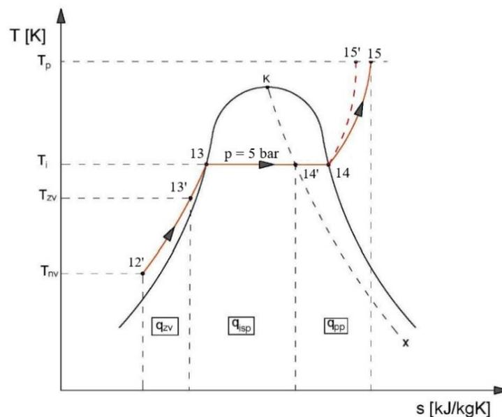
Slika 3.4. T-s dijagram promjene stanja u niskotlačnom utilizatoru
