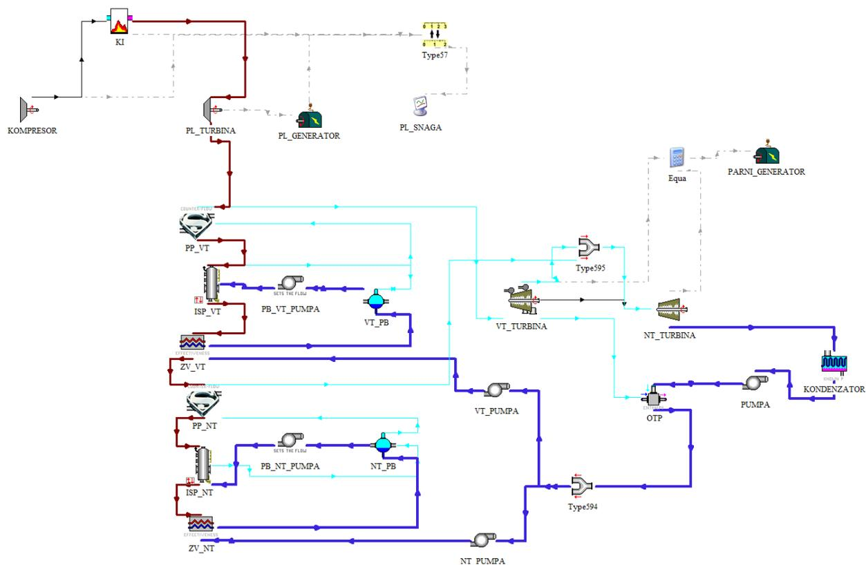
Slika 5.17. Shema kombiniranog parno-plinskog postrojenja bez pretvarača mjernih jedinica i printera
