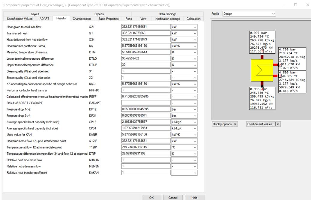
Slika 4.18. Komponenta 26 – niskotlačni pregrijač pare
