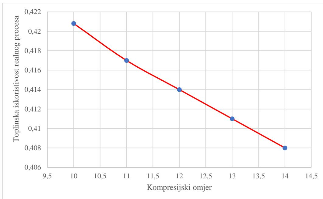
Slika 6.6. Dijagram ovisnosti toplinske iskoristivosti realnog plinsko turbinskog procesa o kompresijskom omjeru
