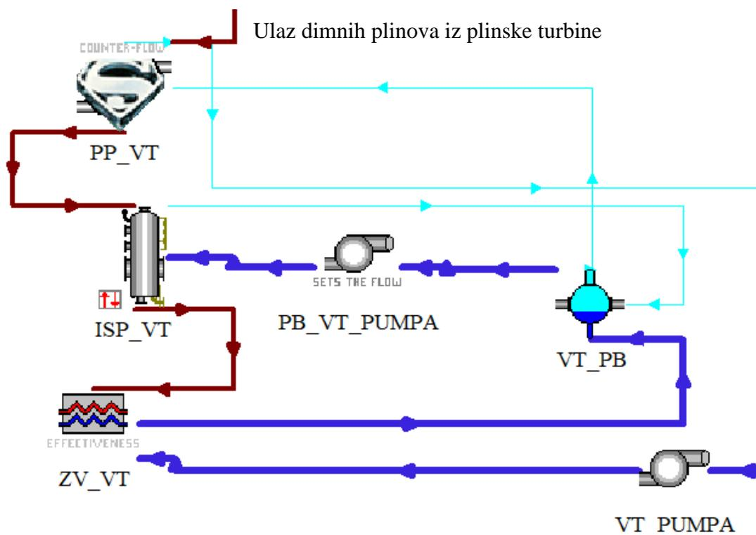
Slika 5.9. Shema visokotlačnog utilizatora u programu TRNSYS
