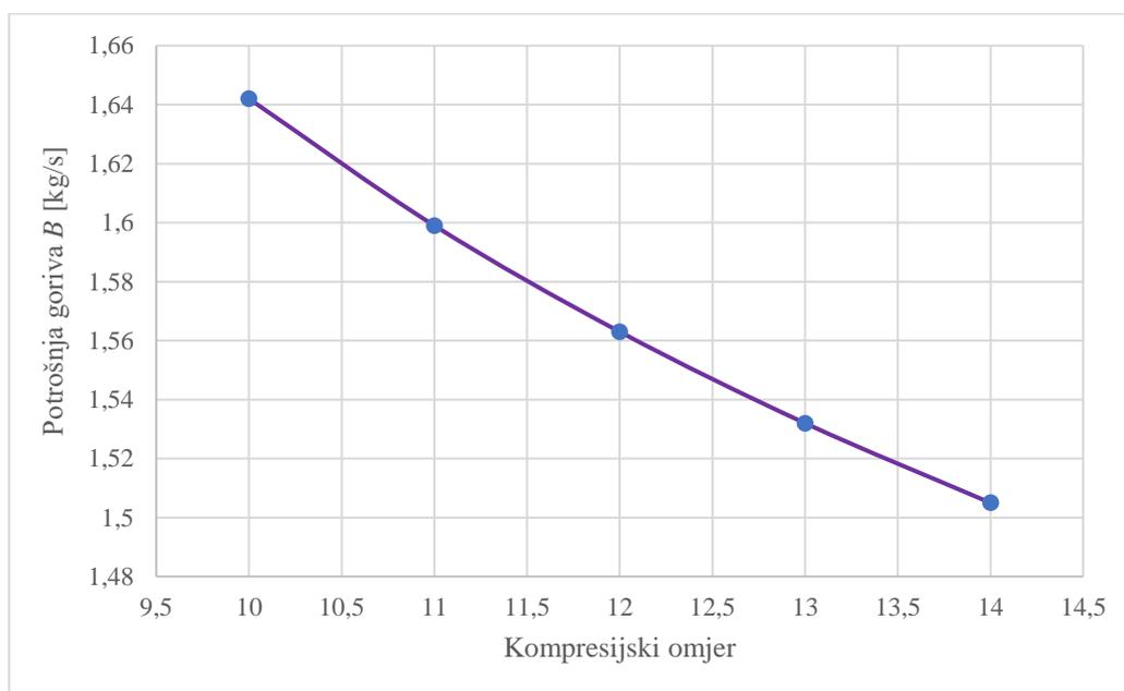
Slika 6.5. Dijagram ovisnosti potrošnje goriva o kompresijskom omjeru
