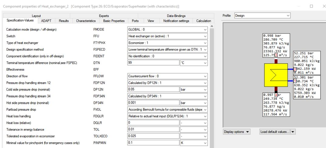
Slika 4.9. Komponenta 26 – visokotlačni zagrijač napojne vode
