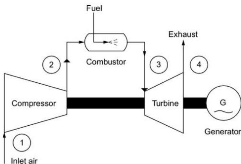
Slika 2.1. Shema otvorenog plinsko-turbinskog procesa [2]
