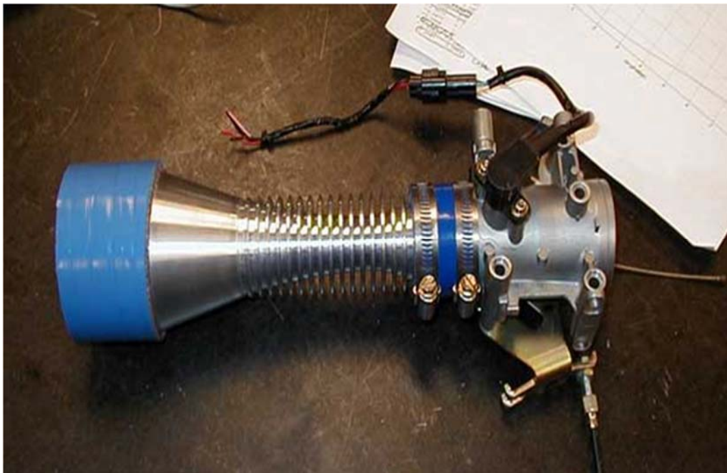
Slika 2.1 Primjer restriktora korištenog u trkaćem autu
