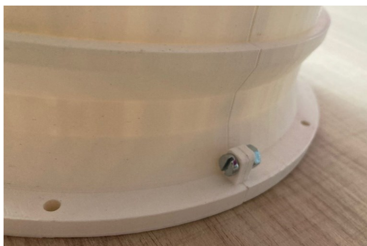
Slika 6.4- Montaža donjeg dijela postolja uz pomoć vijčanog spoja
