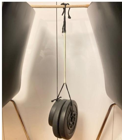
Slika 2.7-Ispitivanje produljenja guma
