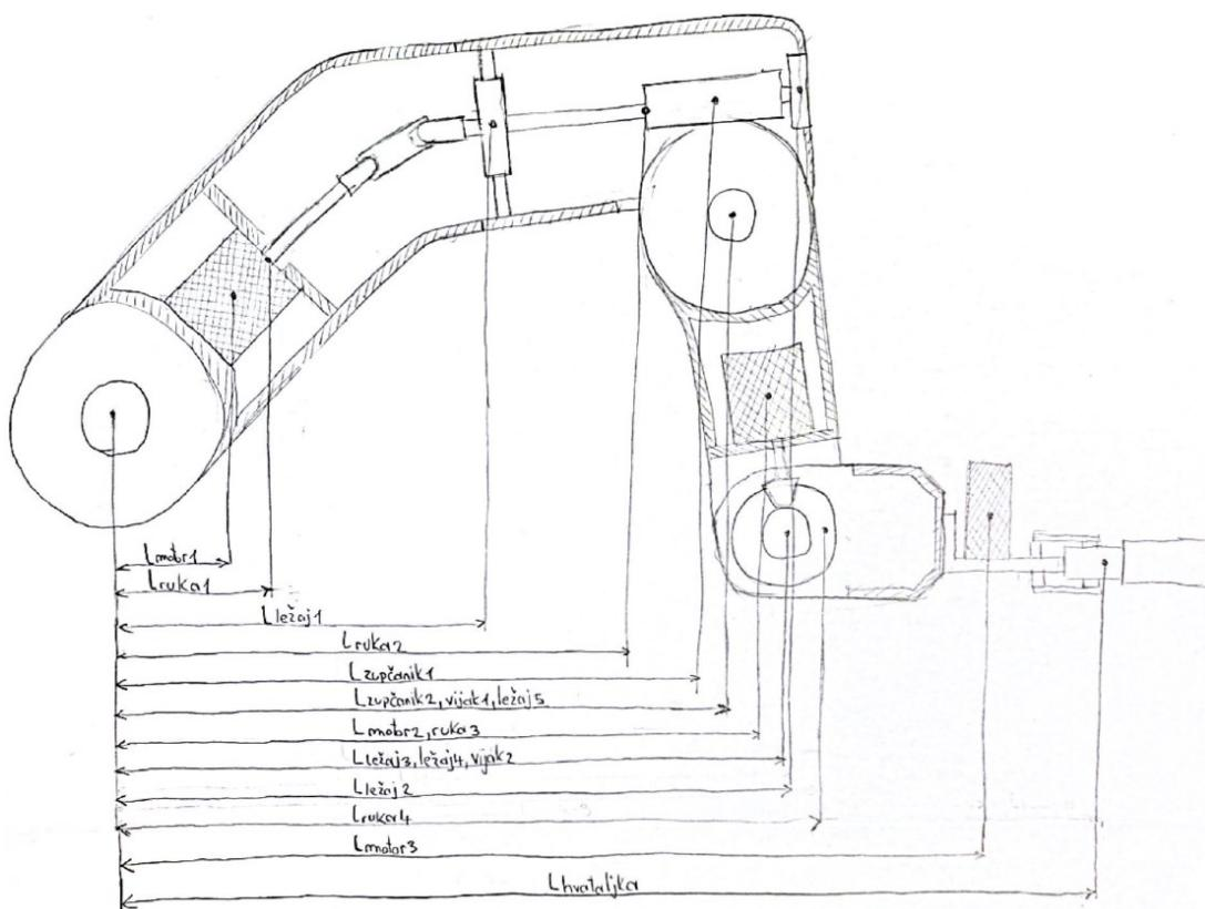
Slika 2.5-Skica s udaljenostima pojedinih elemenata od zgloba 1
