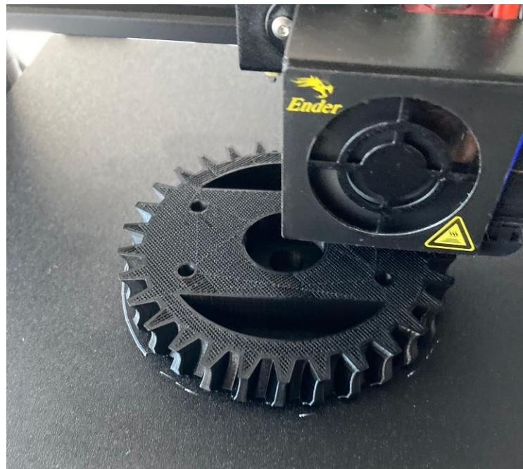
Slika 5.7-Printanje zupčanika s 50% ispunjivosti
