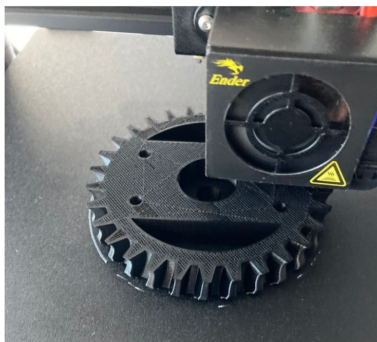
Slika 5.7-Printanje zupčanika s 50% ispunjivosti
