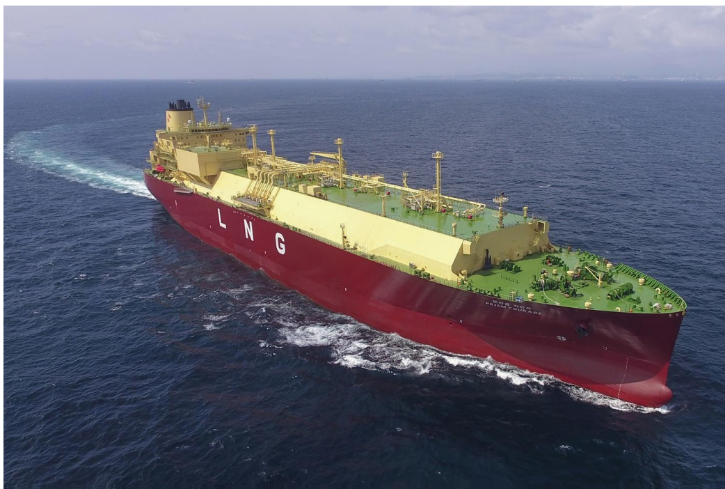
Slika 4.2. LNG tanker za prijevoz ukapljenog plina (kompletno automatiziran s mogućnošću daljinskog upravljanja i vođenja) [17]
