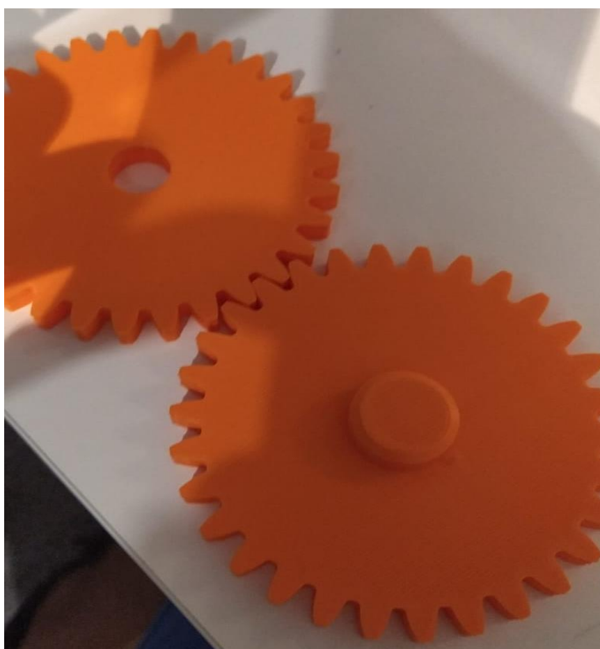
Slika 5.6. Isprintani zupčanici u zahvatu
