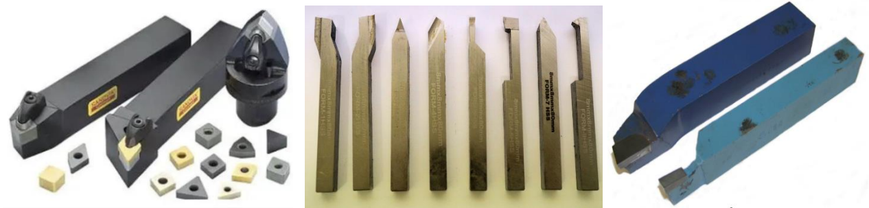
Slika 2.1.1. Tokarski alat s mehanički pričvršćenom reznom pločicom (lijevo), od brzoreznog čelika (sredina) i sa zalemljenom reznom pločicom (desno) [3].
