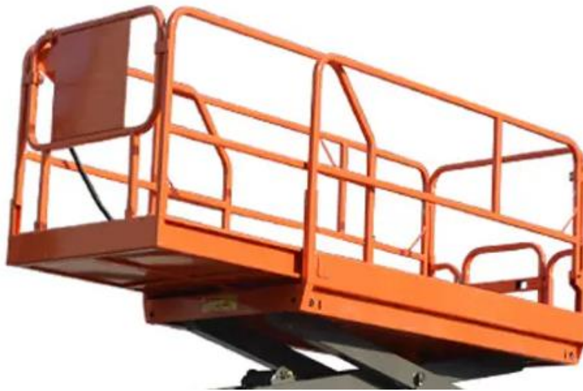
Slika 6. Platforma s zaštitnom košarom
