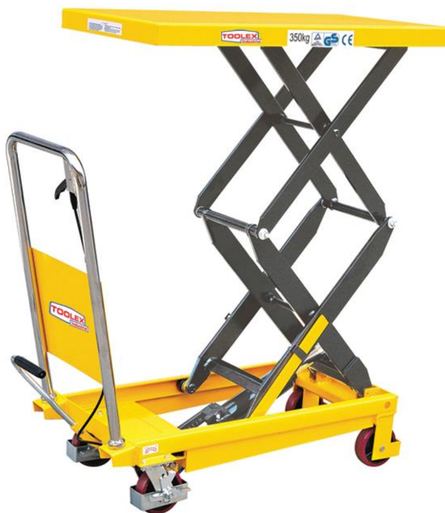
Slika 18. Izvedba podizne platforme u obliku kolica s radnim stolom
