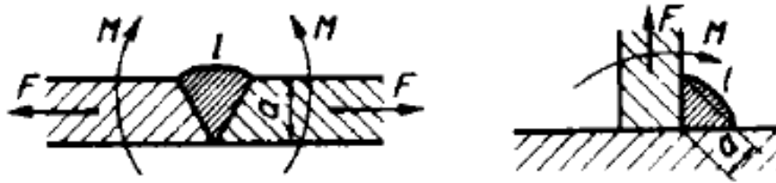
Slika 33. Djelovanje sile i momenta na zavarene spojeve
