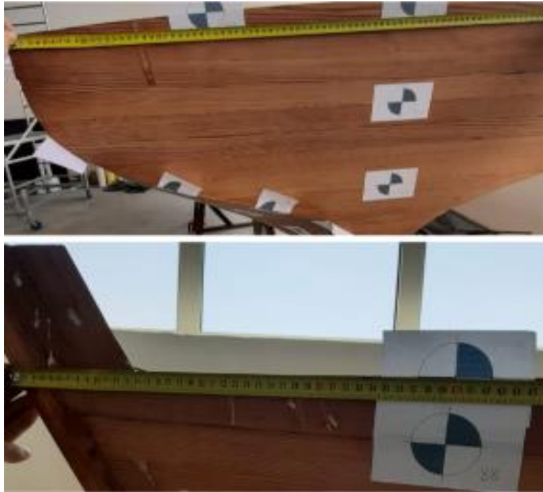
Slika 3.6 Očitavanje točaka na pramčanoj statvi i krmenom zrcalu
