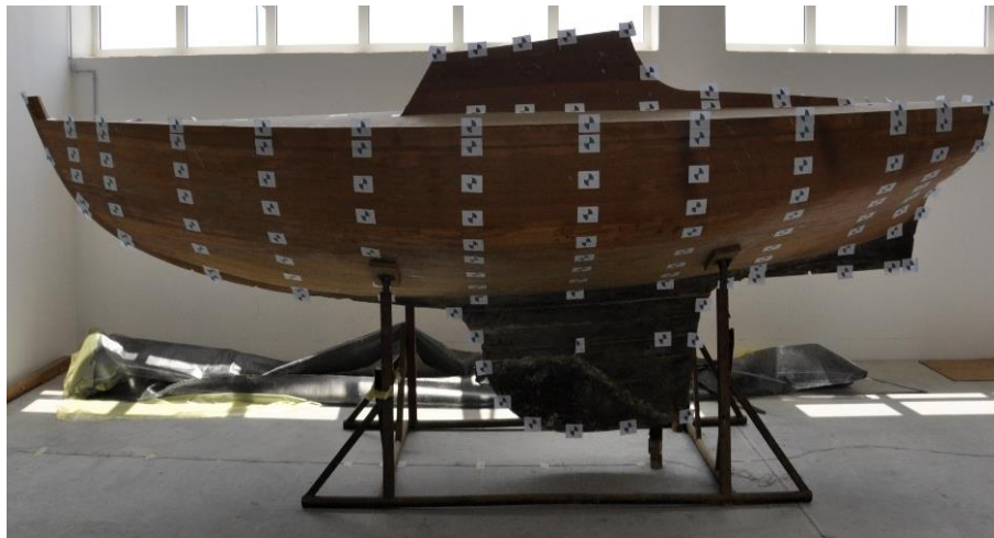
Slika 6.3 Naljepnice na karakterističnim točkama jedrilice
