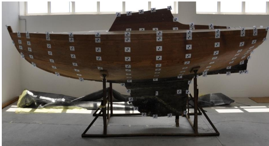
Slika 6.3 Naljepnice na karakterističnim točkama jedrilice
