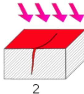
Slika 27. Nanošenje penetranta
