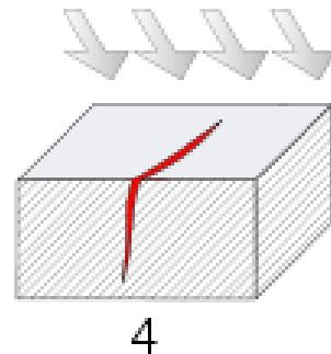
Slika 29. nanošenje razvijača
