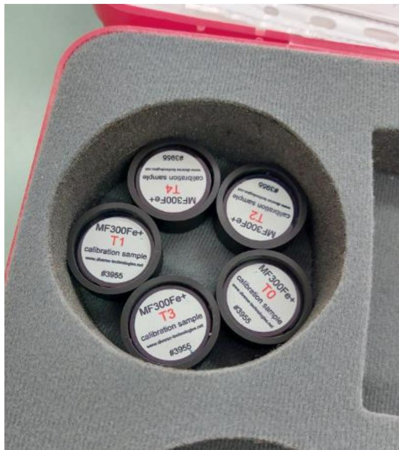
Slika 55. standardni referentni uzorci
