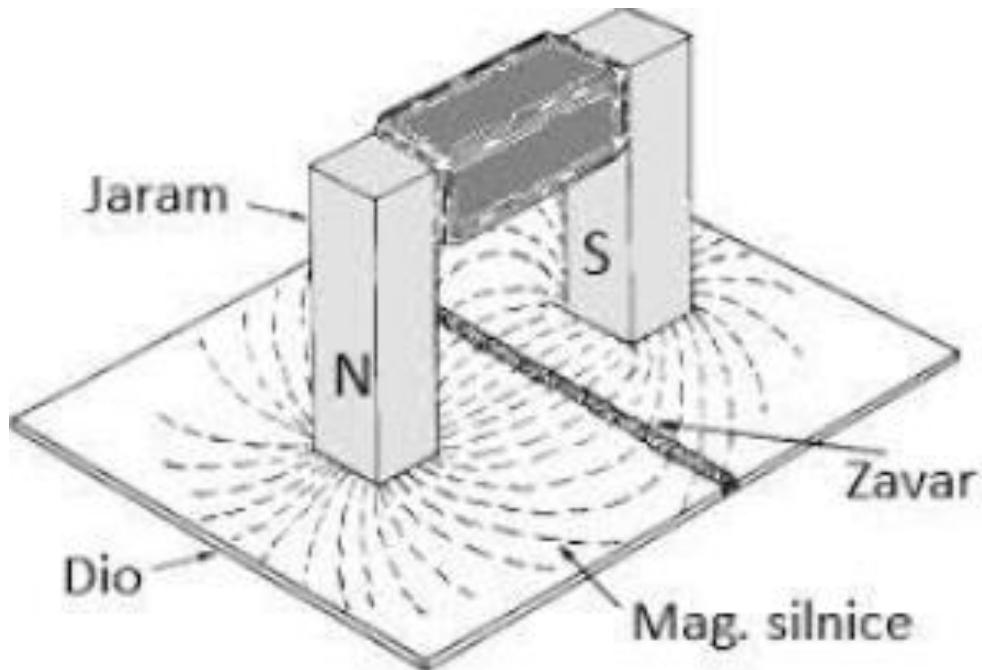
Slika 40.Prikaz rada magnetskog ispitivanja
