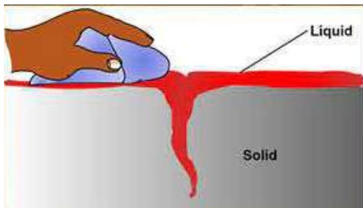
Slika 17 Penetrantno ispitivanje
