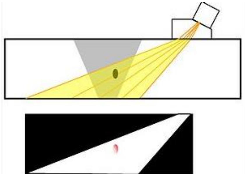
Slika 21 Ultrazvučni mjerač debljine
