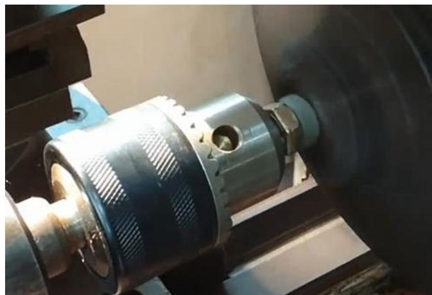
*Slika 12 Zavarivanje trenjem*
