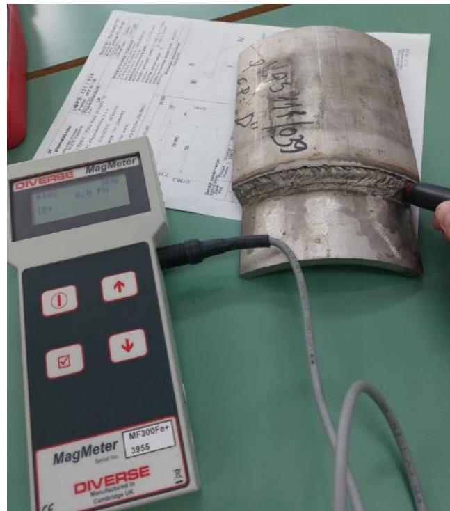
Slika 58. ispitivanje zavara pomoću feritometra i sonde
