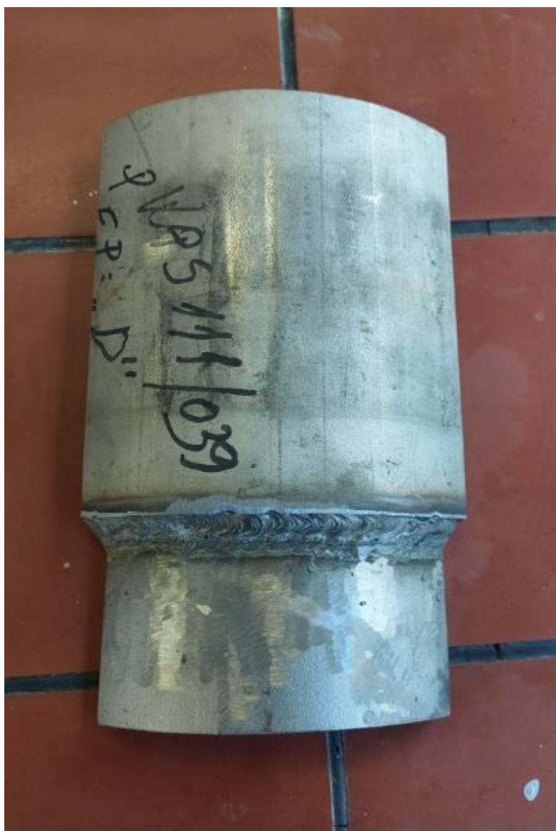
Slika 52. Ispitni dio ET.23-PL.24
