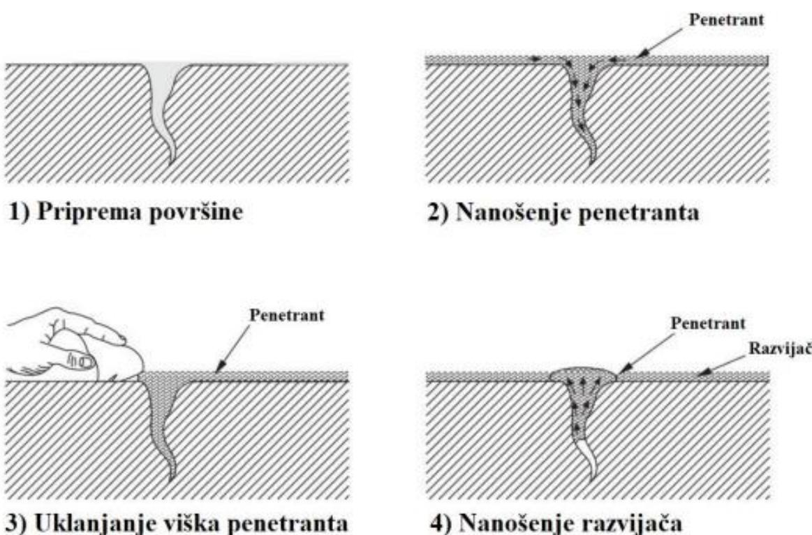
*Slika 30. postupak nanošenja penetrantata*
