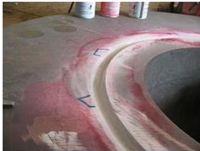
Slika 32. Izgled zavara kod ispitivanja pomoću penetrantata
