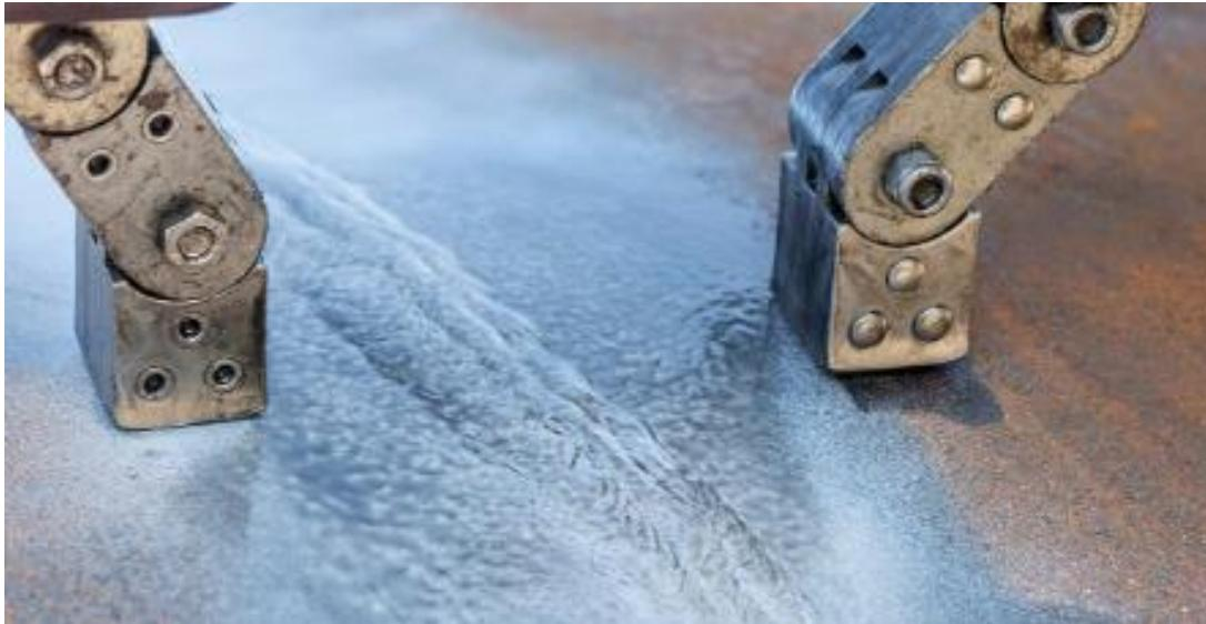
Slika 23 Magnetsko ispitivanje
