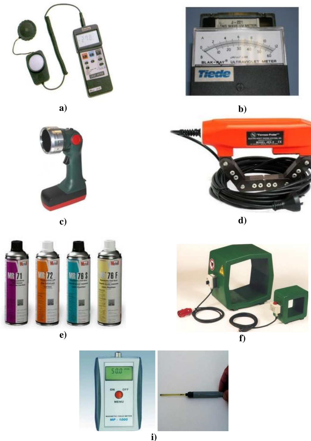
Slika 4.16. Oprema i pribor za ispitivanje magnetskim česticama [5]
