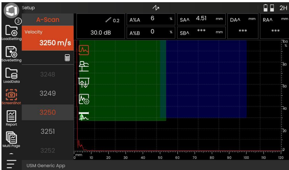
Slika 7.5. Odabir brzine ultrazvuka
