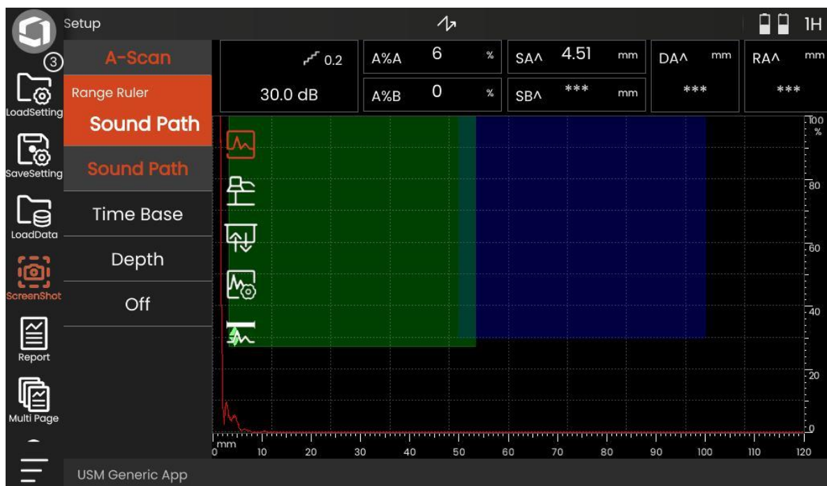
Slika 7.6. Odabir zvučnog puta
