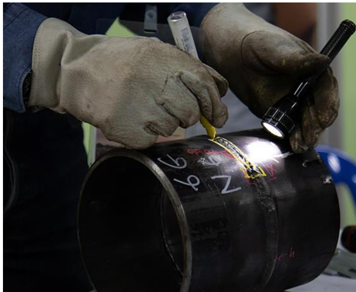
Slika 2.1. Vizualni pregled zavara [3]
