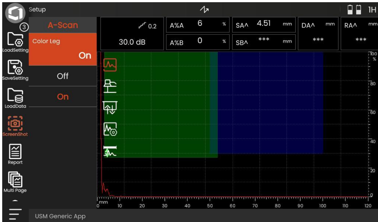
Slika 7.7. Uključivanje Color leg-a
