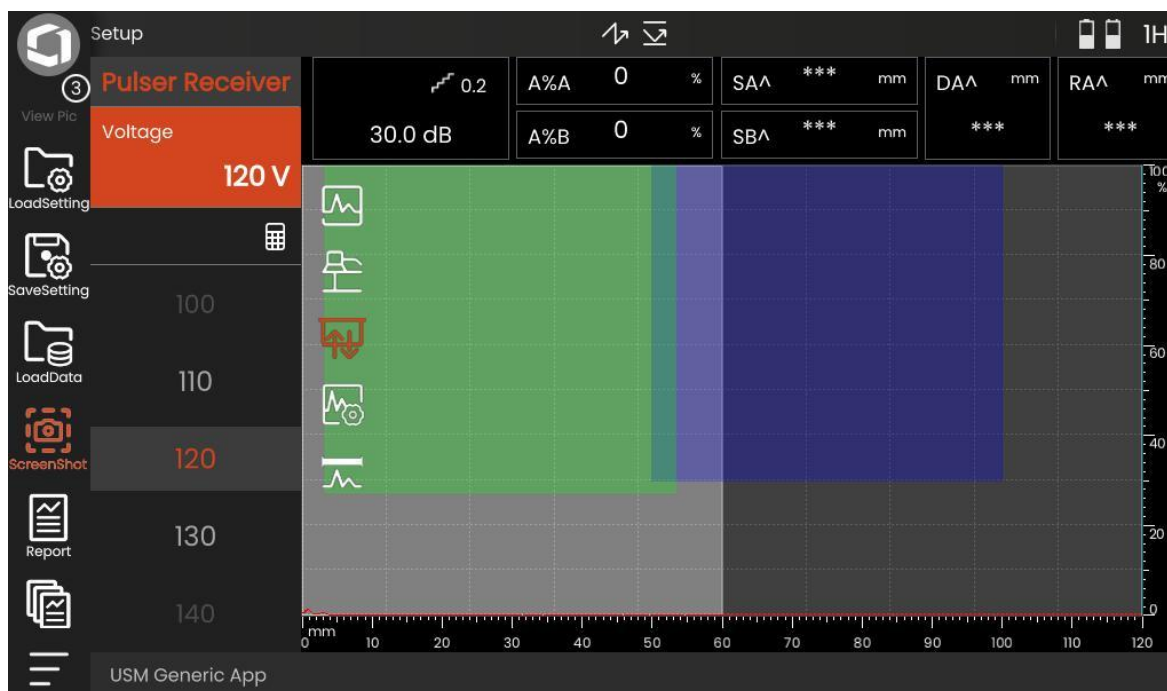
Slika 7.9. Odabir napona sonde
