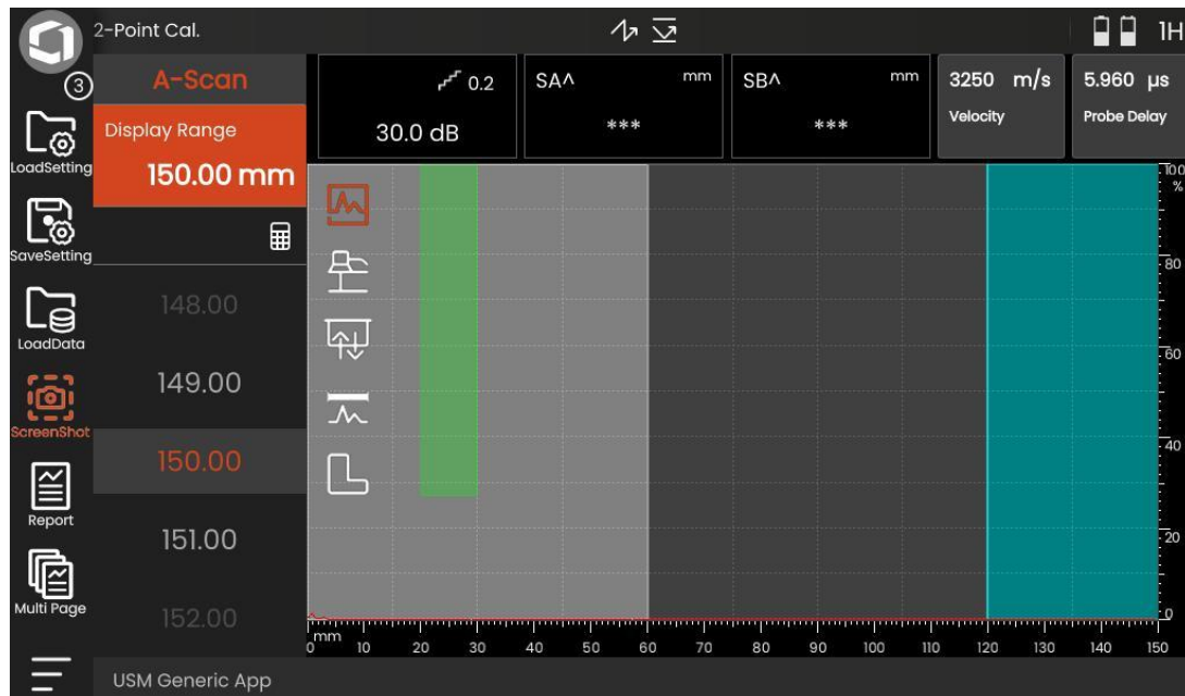
Slika 7.11. Odabir mjernog područja
