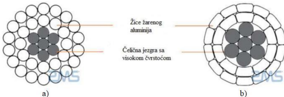
Slika 4.1. ACSS vodič: a) ACSS s Al okruglim žicama, b) ACSS/TW (trapezoidne žice) [30]
