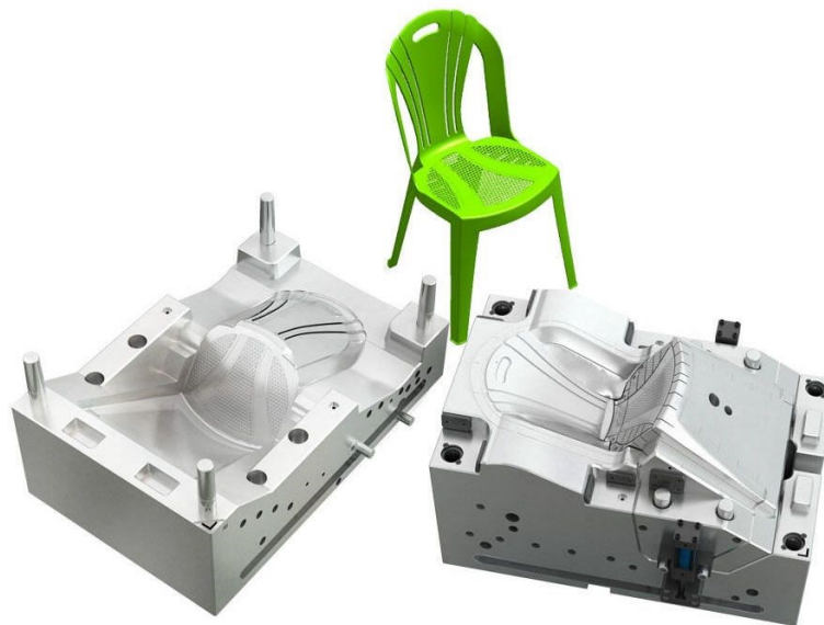
Slika 6.3. Kalup za izradu stolca iz polimera
