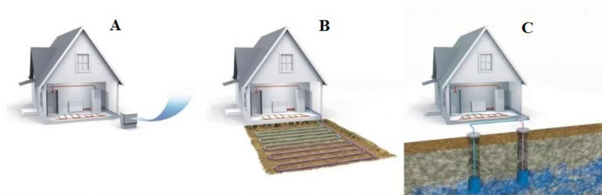
Slika 3.1. Prikaz različitih konfiguracija dizalica topline: a) zrak, b) tlo, c) podzemne vode [4]
