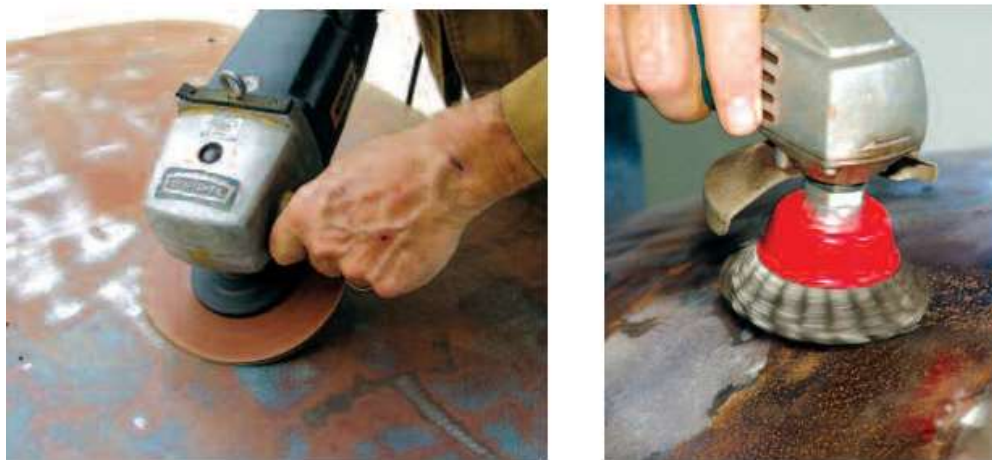
Slika 4.2. Brušenje brusnim papirom i žičanom četkom [12]
