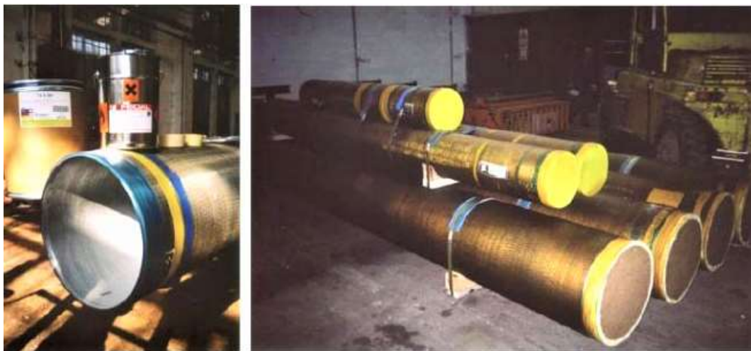
Slika 5.7. Zaštita unutrašnjosti cijevi praškastim inhibitorima [22]
