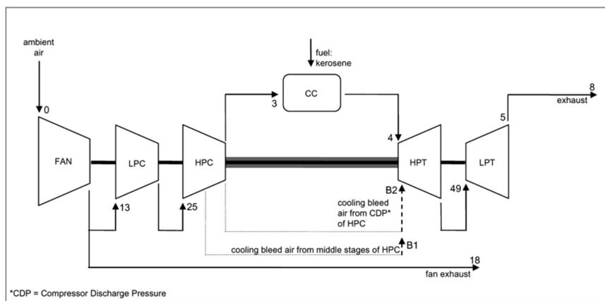
Slika 3.1.1.: Shema prvog turboventilatorskog motora
