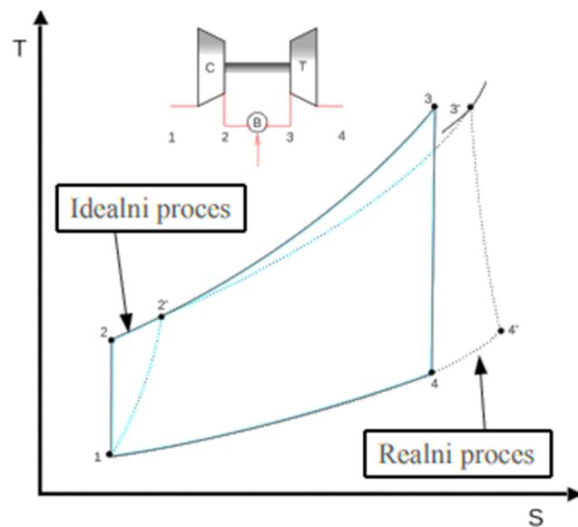
Slika 2.2.2: Usporedba stvarnog i realnog Braytonovog procesa [2]
