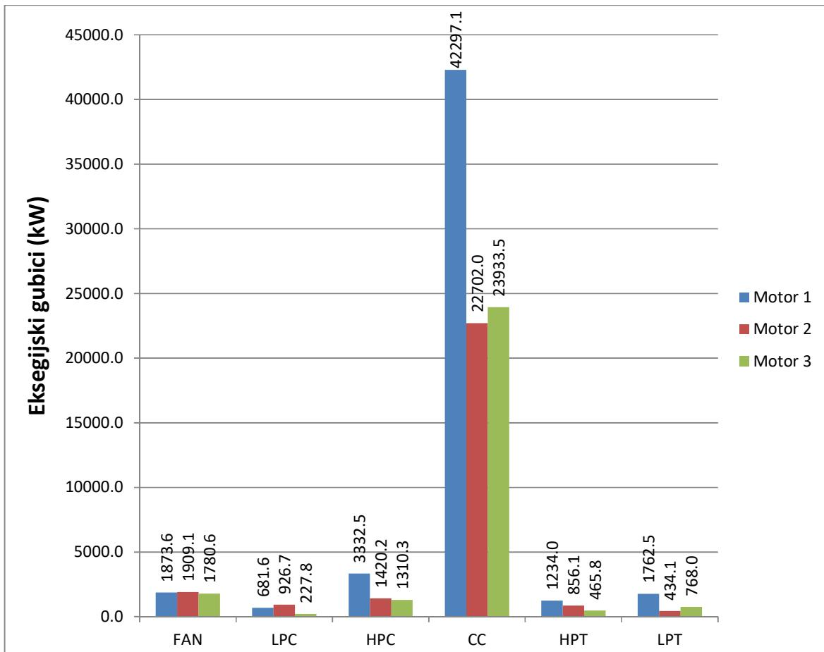
Slika 4.2.2.: Usporedba eksergijskih gubitaka pojedinih komponenti motora
