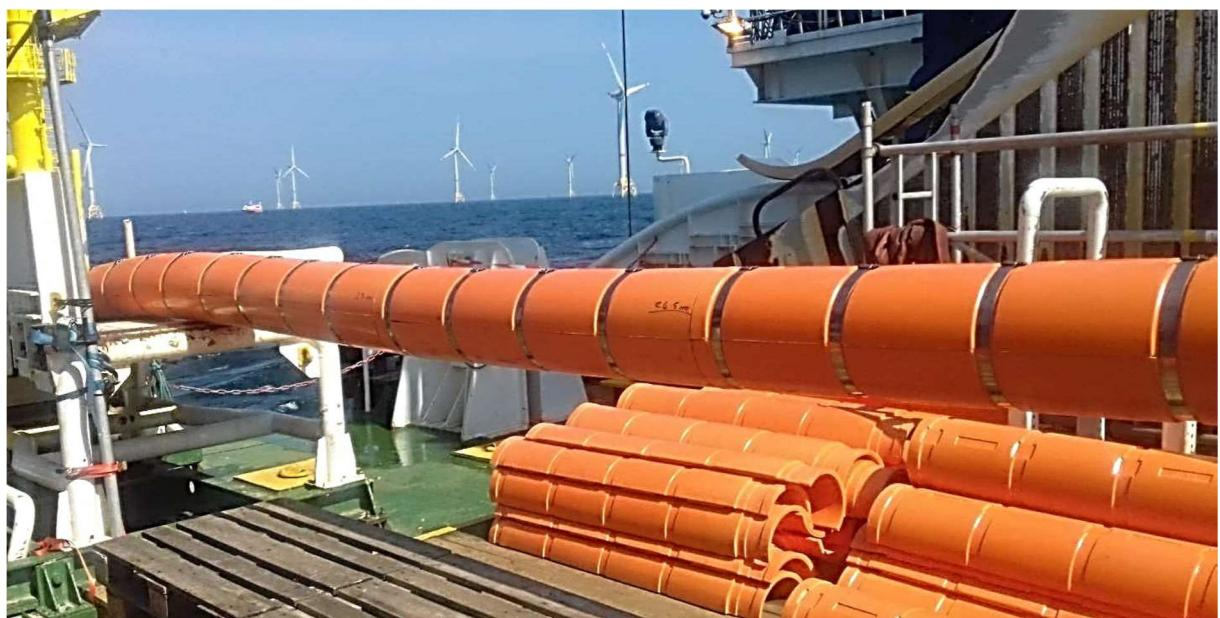
Slika 7.10: Polimerni oklop za zaštitu kabela [1]
