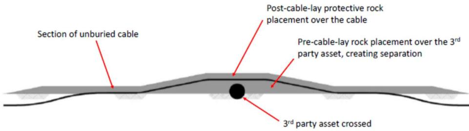
Slika 5.6: Primjer polaganja kabela iznad elementa treće strane [1]
