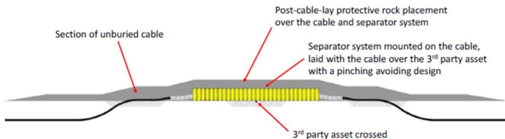
Slika 5.11: Sustav separatora prijelazne konstrukcije oko kabela – zaštitni kameni sloj preko kabela [1]
