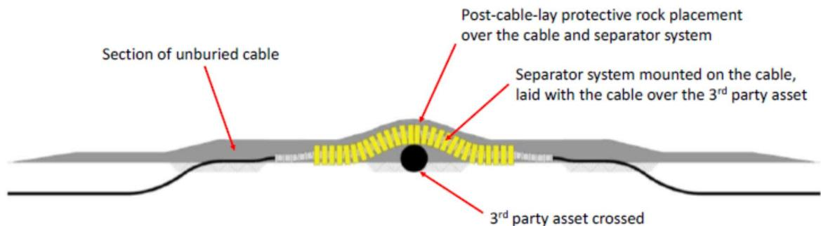
Slika 5.10: Sustav separatora prijelazne konstrukcije oko kabela – zaštitni kameni sloj preko cijevi [1]
