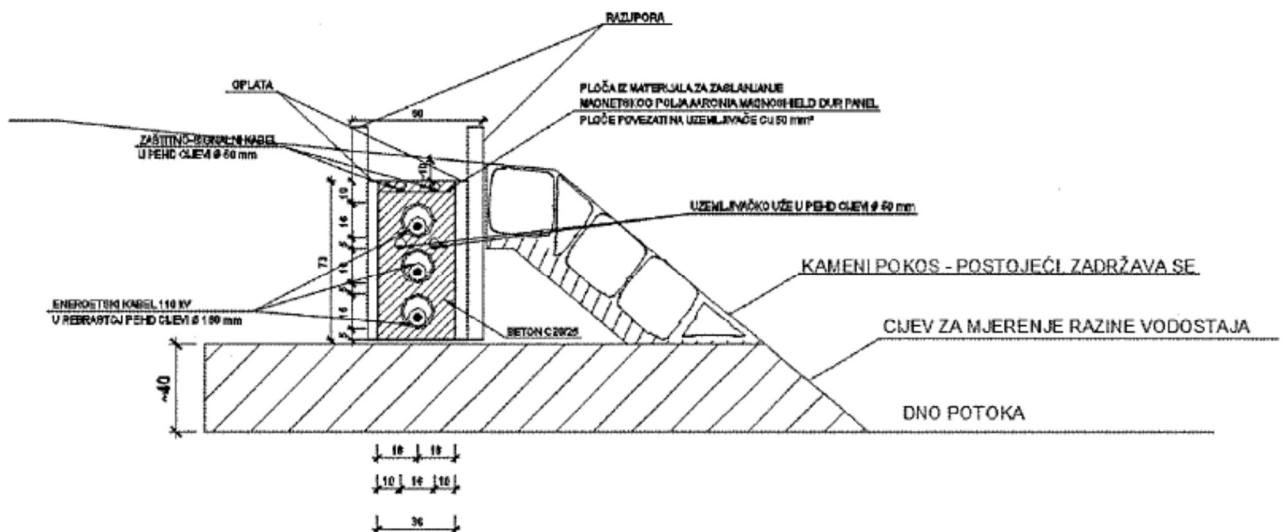
Slika 9.4: Poprečni presjek kabelskog rova s podzemnim kabelima smještenim u zaštitnim PEHD cijevima promjera 160 mm u zaštitnom betonskom bloku [7]
