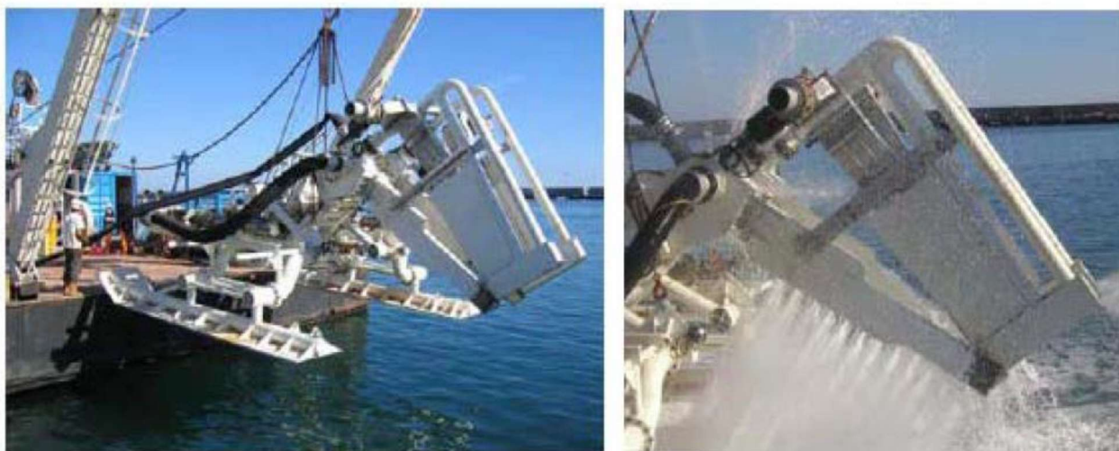
Slika 7.3: Alat za mlazni ukop [1]
