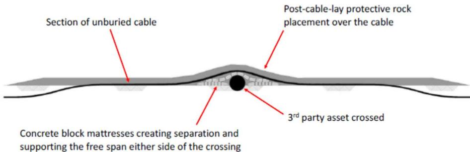
Slika 5.7: Postavljanje kabela s odvajanjem stijenom od elementa treće strane [1]
