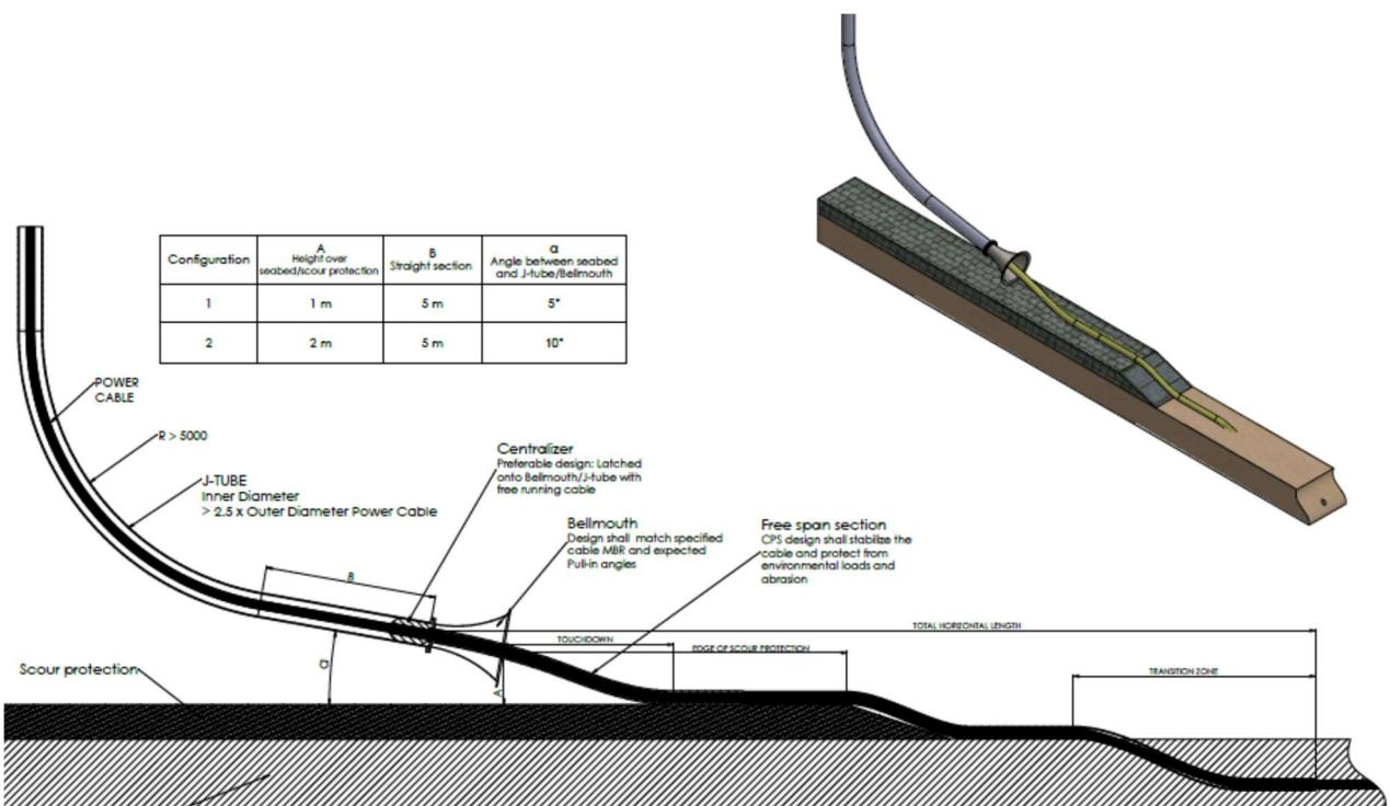
Slika 5.5: J – cijev i raspored kabela [1]
