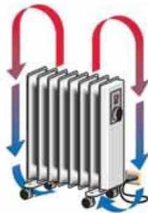
Slika 3.4. Tipičan model slobodne konvekcije
