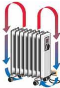
Slika 3.4. Tipičan model slobodne konvekcije
