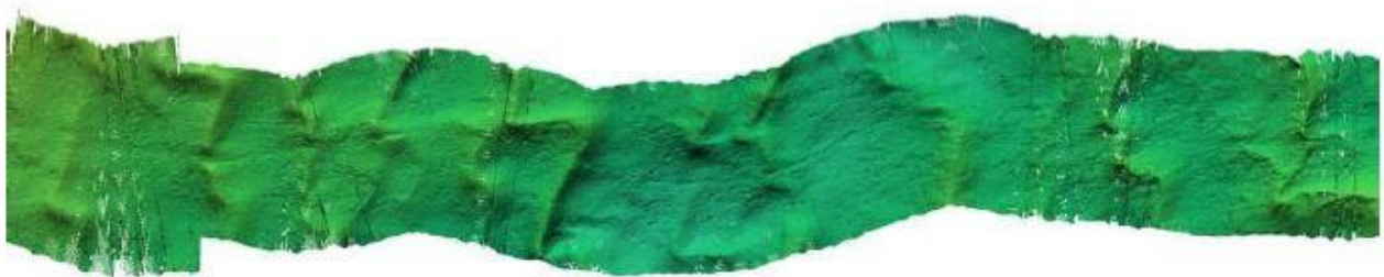
Slika 5.1. Slika dobivena batimetrijskim mjerenjem koja prikazuje pješčane valove [10]
