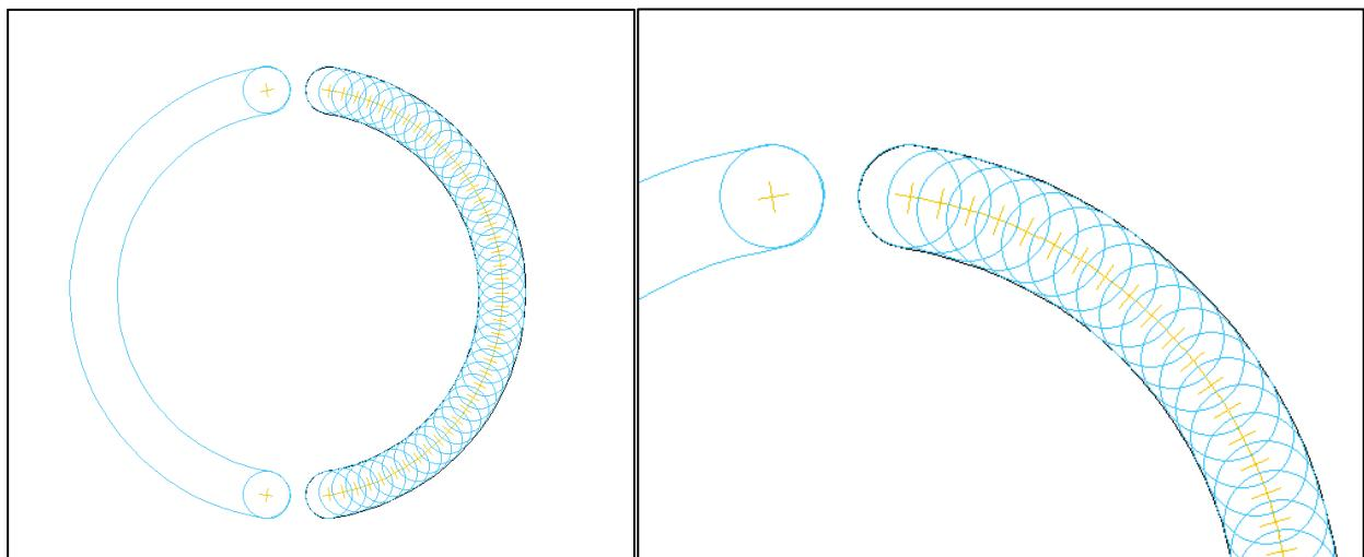
Slika 3.8. Prikaz broja udaraca alata Ø3
