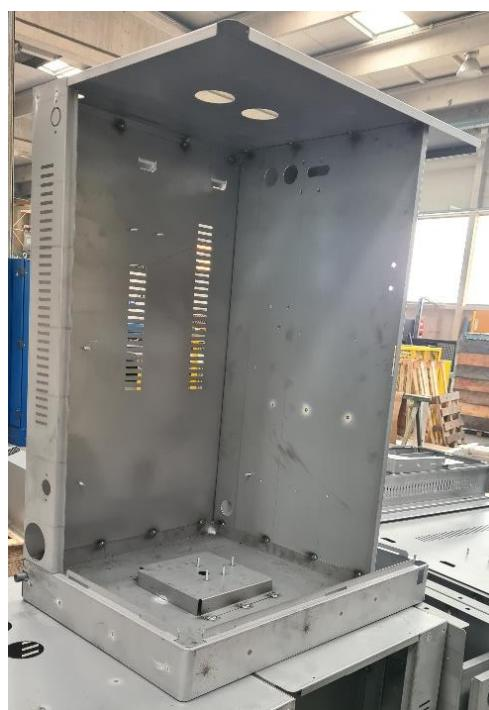
Slika 3.15. Montaža pozicija u sklop zavarivanjem
