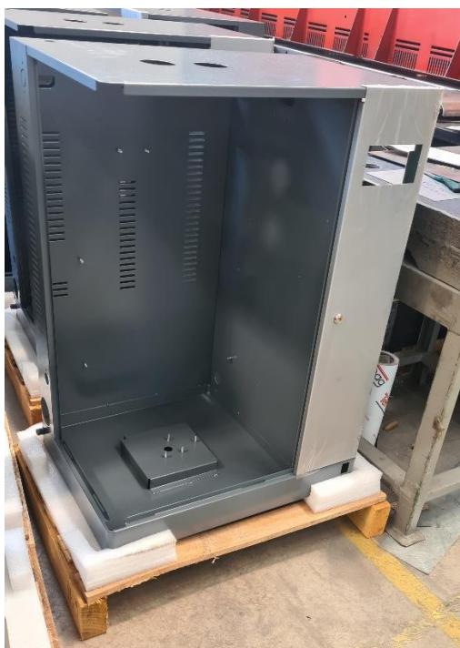
*Slika 3.16. Sklop kućišta nakon elektrostatskog praškastog farbanja*
