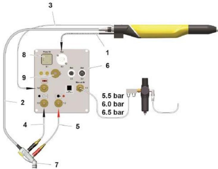
Slika 6.7. Shema spajanja automatskog pištolja i upravljačke jedinice [12]
