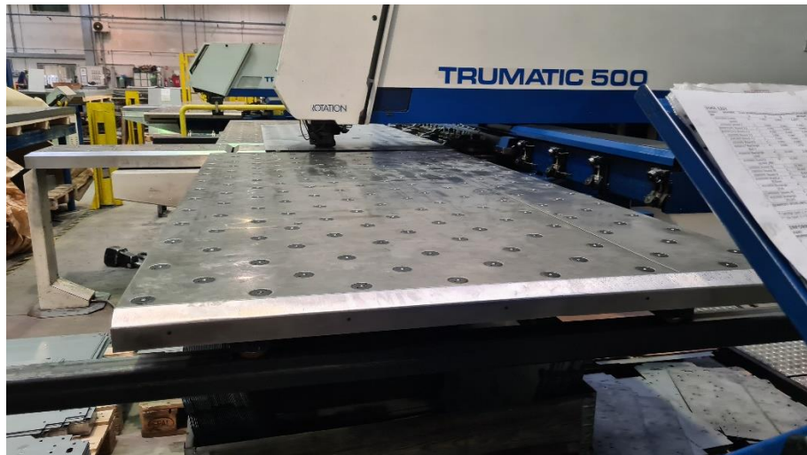
Slika 3.12. Probijanje na stroju TC-500
