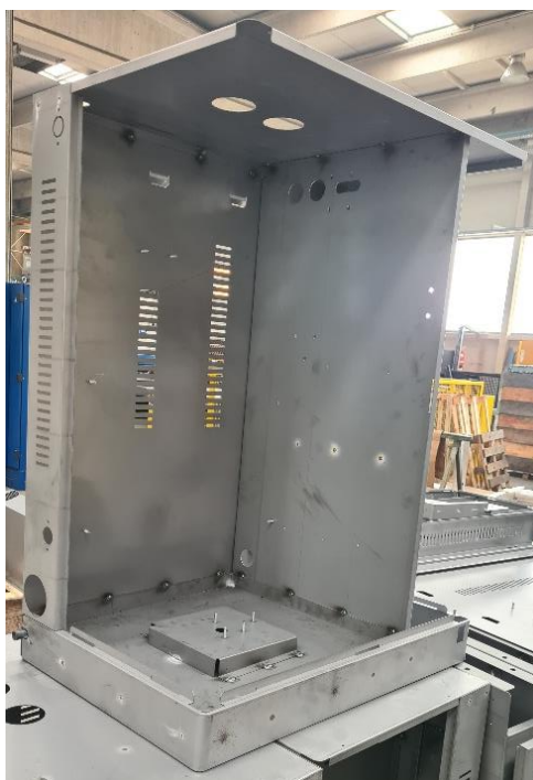
Slika 3.15. Montaža pozicija u sklop zavarivanjem
