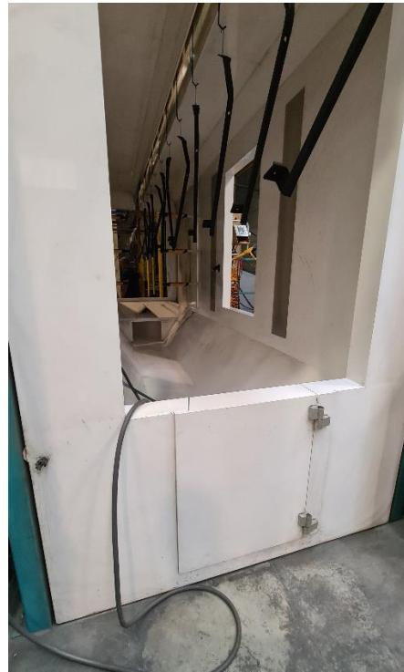
*Slika 2.1. Nanošenje praha u komori*
