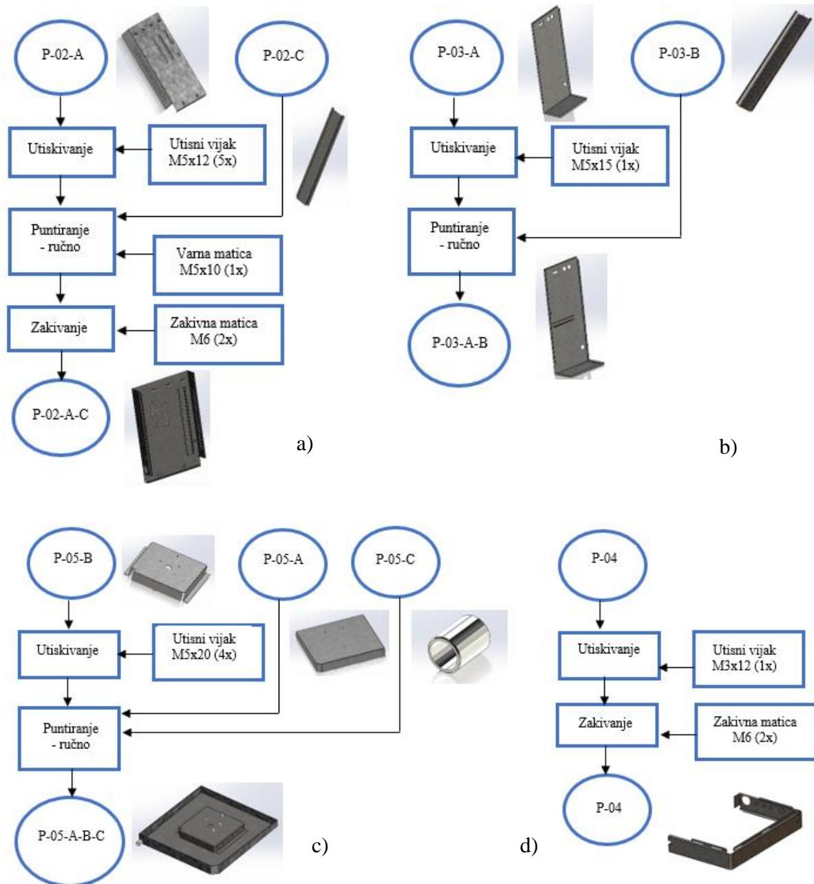
Slika 4.3. Dijagram toku izrade podsklopova leđa (a), nosača (b) i postolja (c, d)
