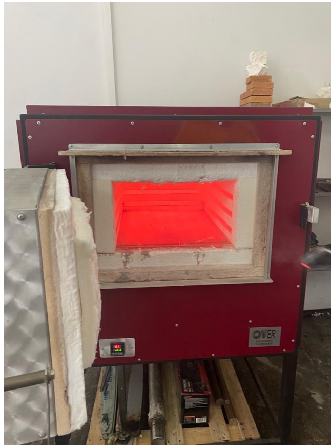
Slika 5.3 Vađenje uzoraka iz peći za toplinsku obradu
