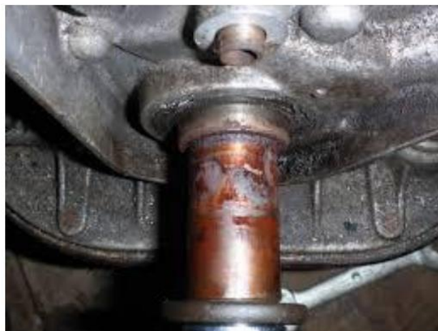
Slika 3.17 Primjeri oštećenja tarnom korozijom [8]
