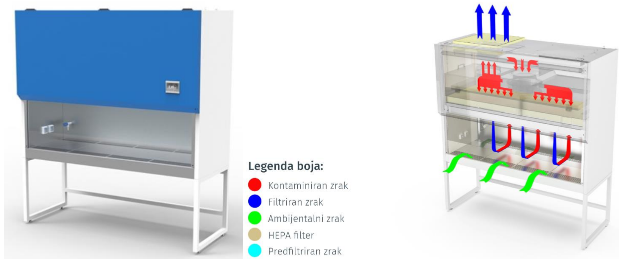
Slika 2.9. Primjer mikrobiološkog zaštitnog uređaja [1]
