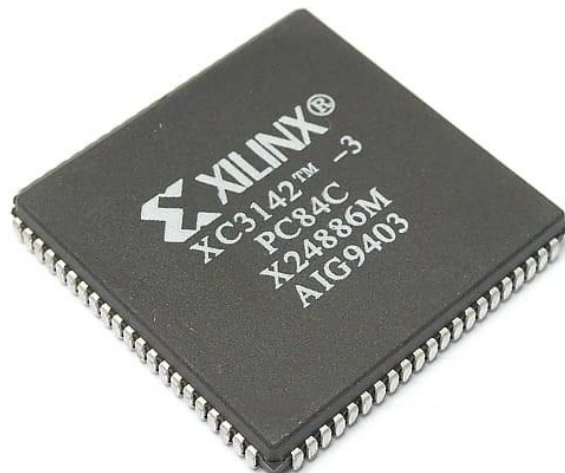
Slika 2.1. Primjer modernog FPGA čipa u SMD izvedbi.
