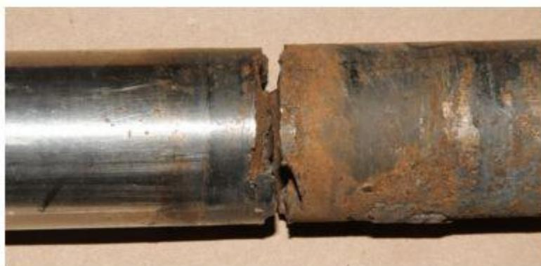
*Slika 2.24.: Lom vratila uslijed korozijskog zamora [3]*
