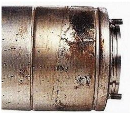
Slika 2.12.: Rupičasta (pitting) korozija dijela osovine od nehrđajućeg čelika [10]
