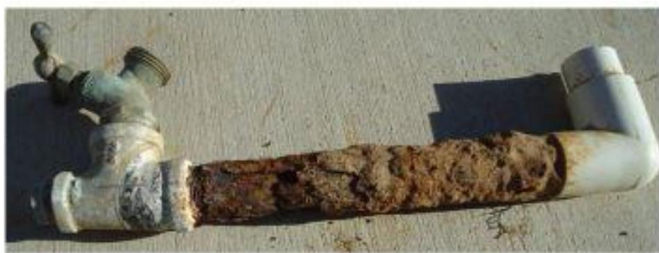
Slika 2.18.: Galvanska (kontaktna, bimetala) korozija [3]
