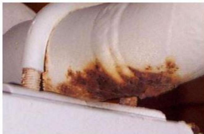
Slika 2.17.: Primjer oštećenja metala uslijed korozije u procjepu [3]
