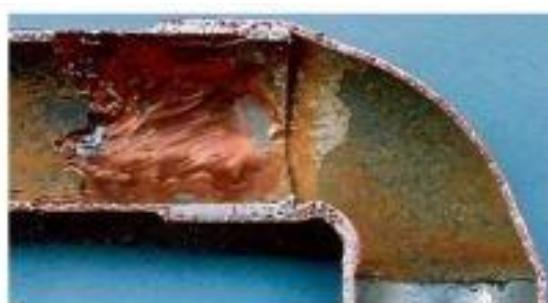
*Slika 2.26.: Erozija korozija bakrenog cjevovoda [3]*
