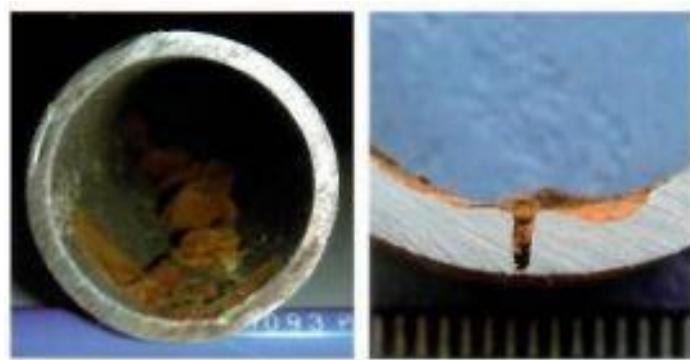
Slika 2.22.: Bakterijska korozija cjevovoda pitke vode [3]
