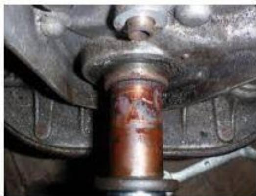
*Slika 2.25.: Primjer oštećenja nastao tarnom korozijom [3]*
