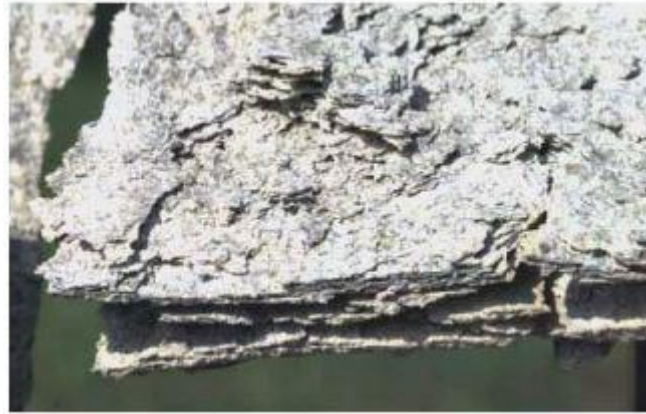
slika 2.15.: Eksfolijacija Al-legure u morskoj atmosferi [3]
