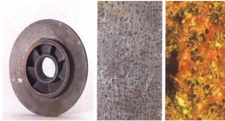
Slika 2.20.: Primjer grafitizacije čelika [11]
