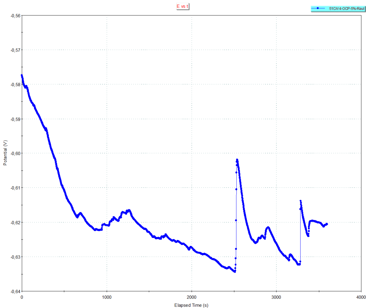
Slika 4.11.: Varijacija električnog potencijala otvorenog strujnog kruga u odnosu na vremenski period (5% NaCl)
