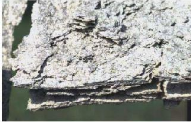
slika 2.15.: Eksfolijacija Al-legure u morskoj atmosferi [3]
