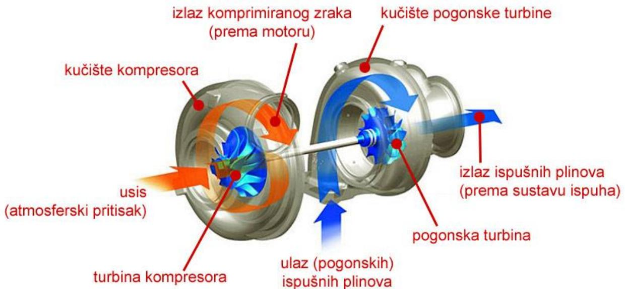
*Slika 4.2 Osnovni elementi turbopuhala [11]*
