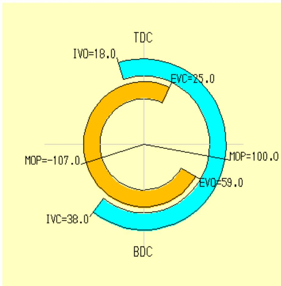
Slika 5.8 Kutovi otvaranja i zatvaranja ventila [autor]
