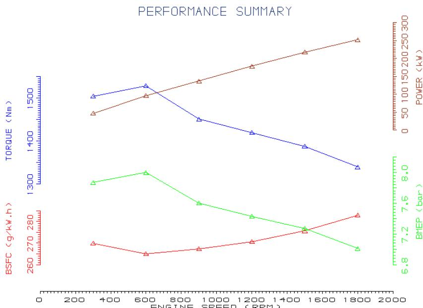
Slika 6.1 Dijagram snage, okretnog momenta, specifične potrošnje goriva i srednjeg efektivnog tlaka u ovisnosti o brzini vrtnje
