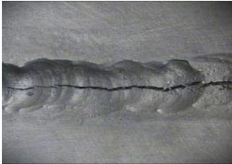
*Slika 8.1. Topla pukotina, lice zavarenog spoja*
