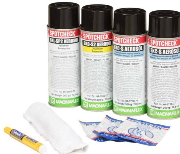
*Slika 3.1. Set za ispitivanje penetrantima u boji [8]*
