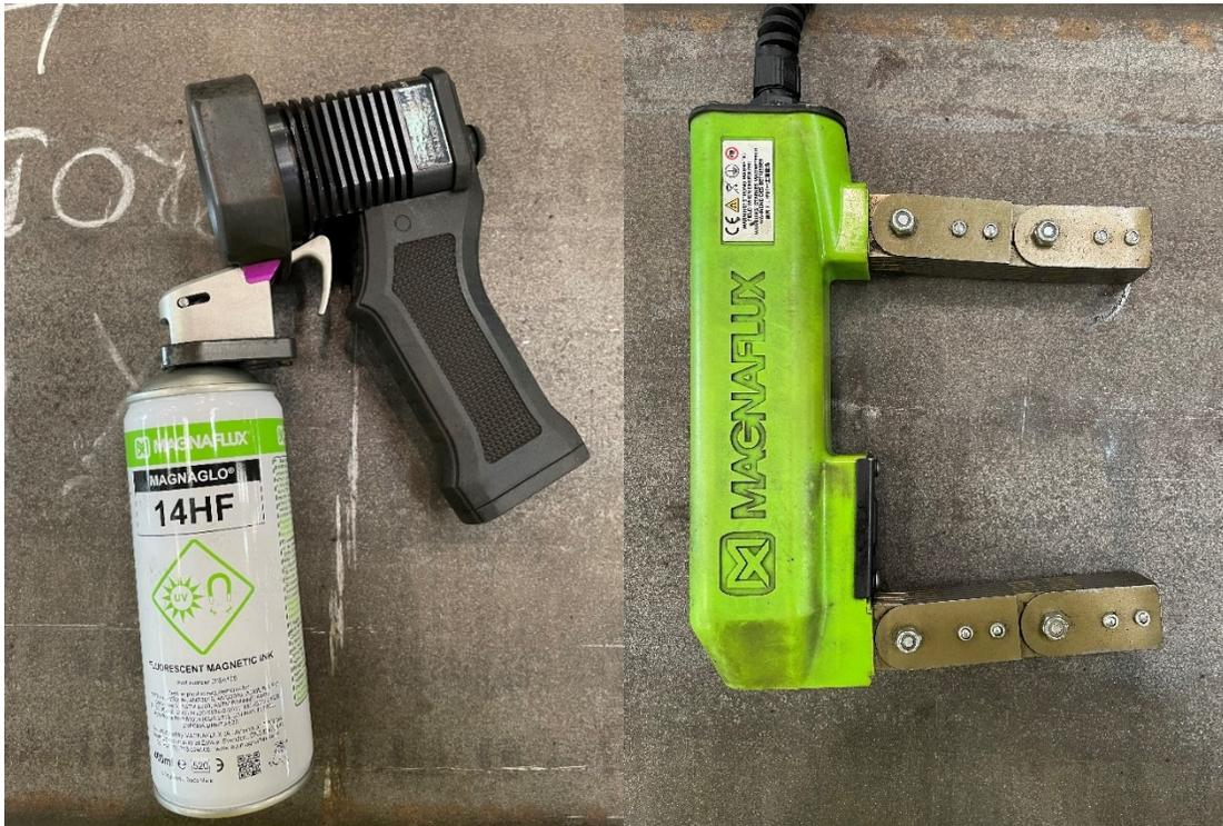
*Slika 9.7. Oprema za ispitivanje magnetskim česticama*
