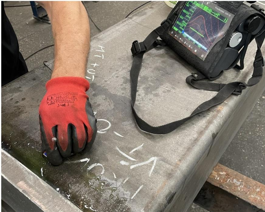
*Slika 9.10. Ultrazvučni uređaj USM 36*
