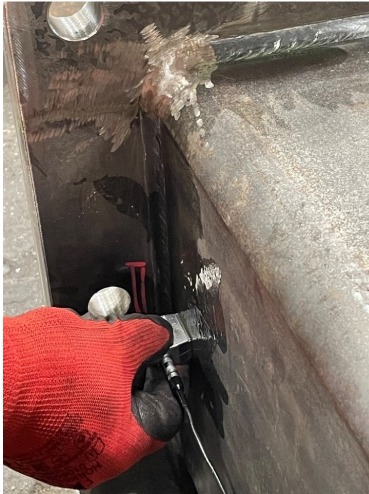
Slika 9.9. Kutno skeniranje zavarenog spoja
