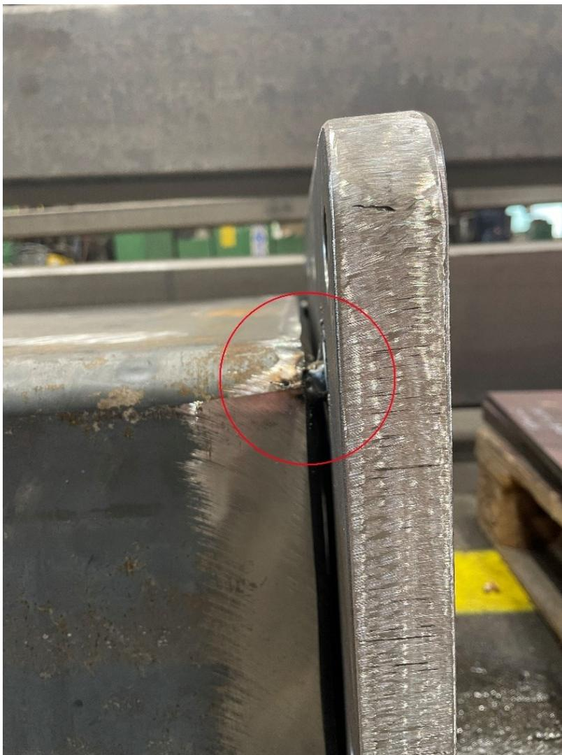
Slika 9.3. Pripojno zavarivanje spojnih elemenata
