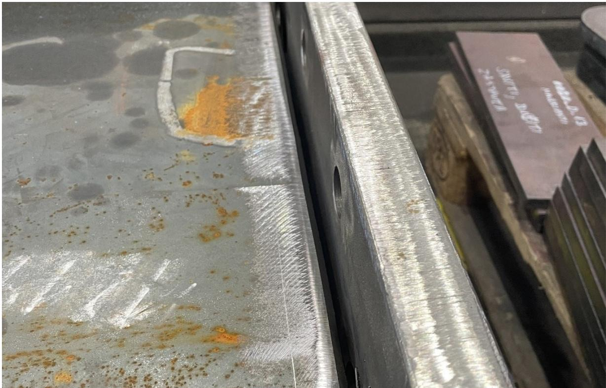
*Slika 9.2. Priprema površine i oblikovanje elemenata za zavarivanje*
