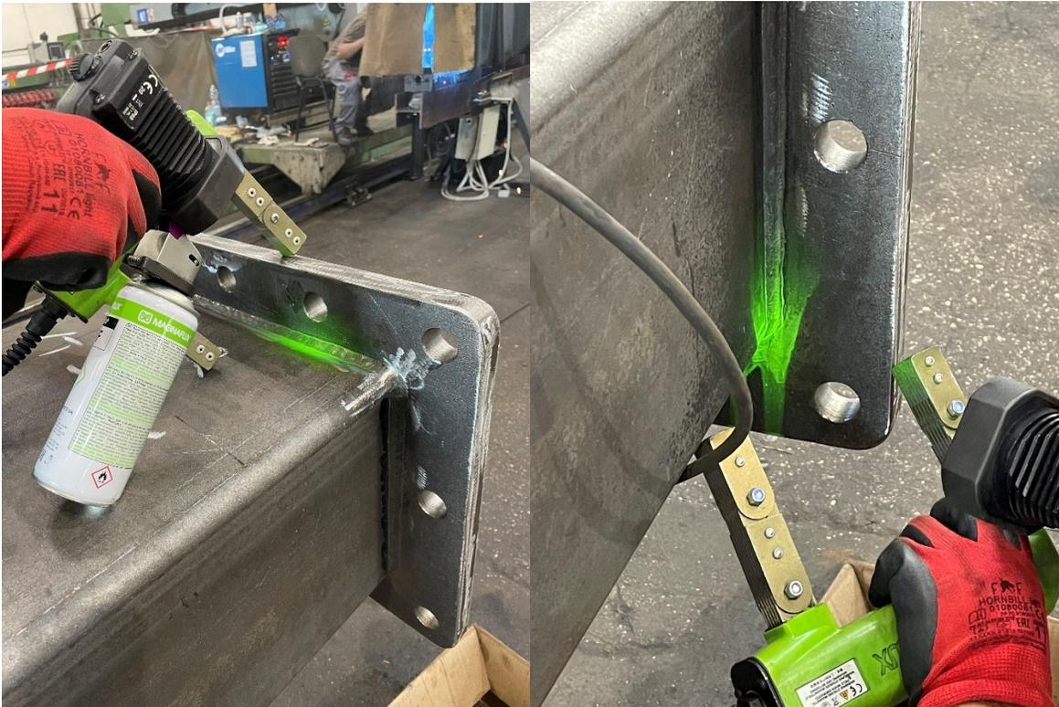
Slika 9.8. Ispitivanje fluorescentnim magnetskim česticama
