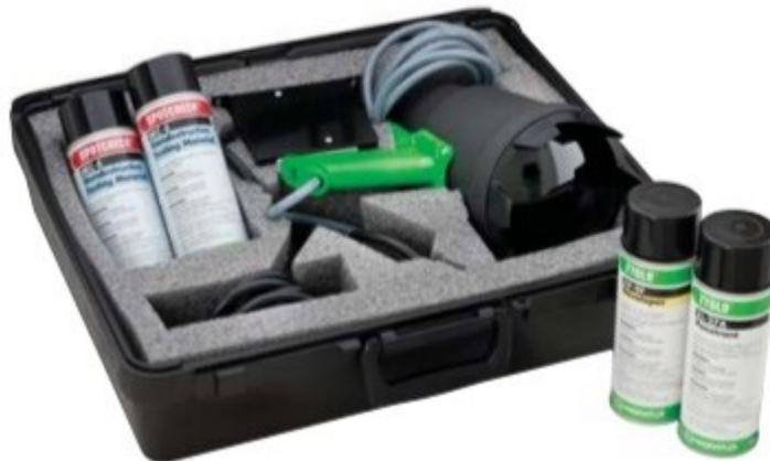
*Slika 3.2. Set za ispitivanje fluorescentnim penetrantima [8]*
