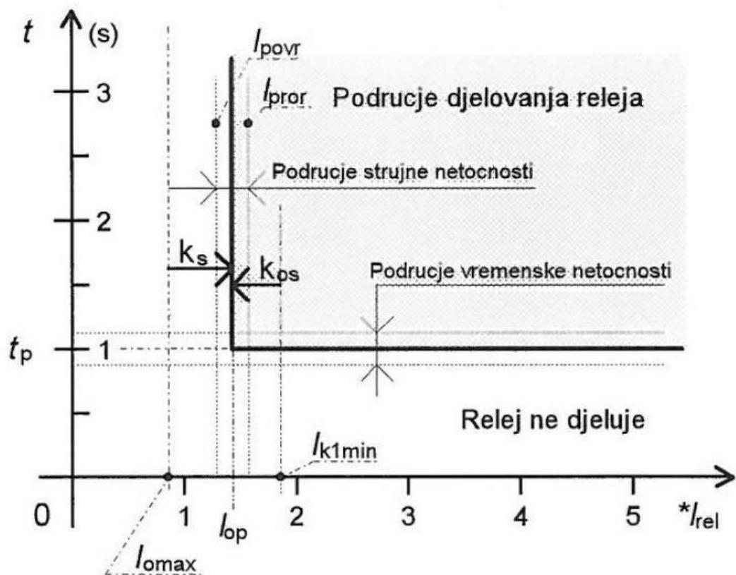
Slika 7.2. Radna karakteristika nadstrujnog releja za jednopolne kvarove
