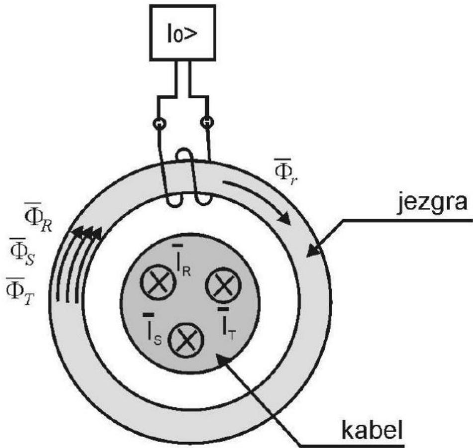
Slika 5.5. Magnetski tokovi u jezgri strujnog obuhvatnog transformatora
