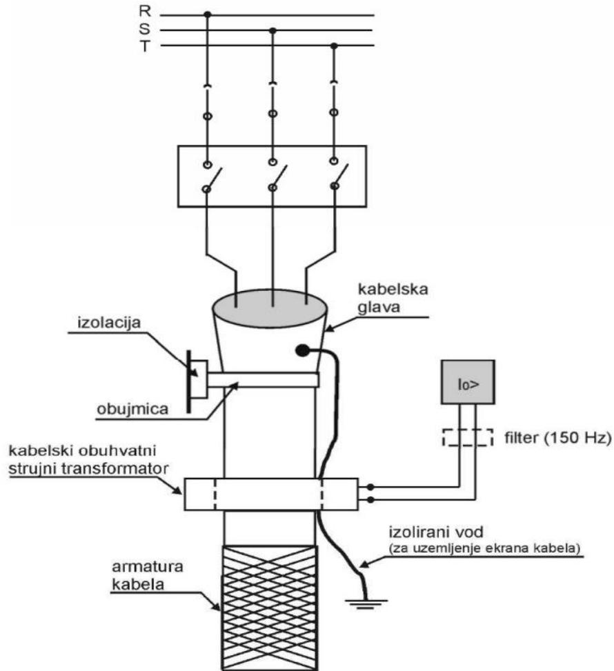
Slika 5.3. Način spajanja kabelskog obuhvatnog strujnog transformatora
