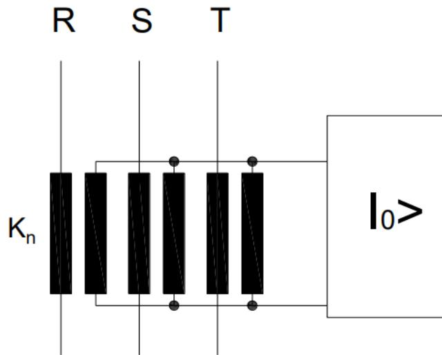
Slika 7.1. Spoj nadstrujnog releja za jednopolne kvarove
