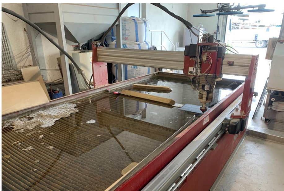
Slika 6.20. Stroj za rezanje vodenim mlazom
