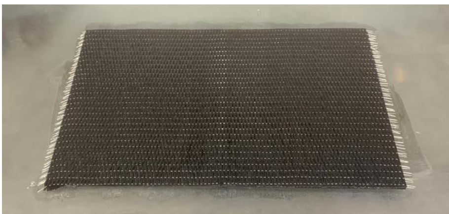
Slika 6.6. Izgled završnog laminata izrađenog ručnim dodirnim postupkom nakon sušenja smole
