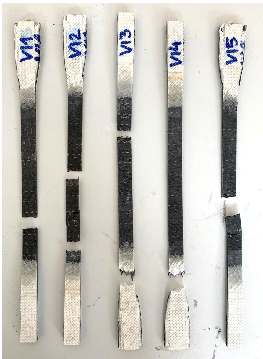
Slika 6.56. Uzorci izrađeni vakuumskim infuzijskim postupkom nakon testiranja
