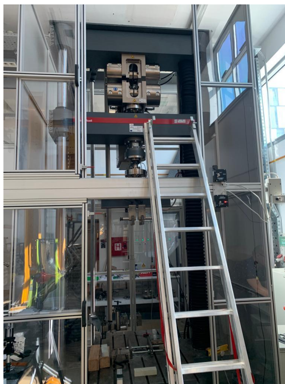
Slika 6.33. Kidalica Zwick/Roell Z600, radni prostor
