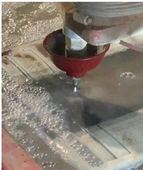
Slika 6.22. Prikaz rezanja vodenim mlazom iz bliza
