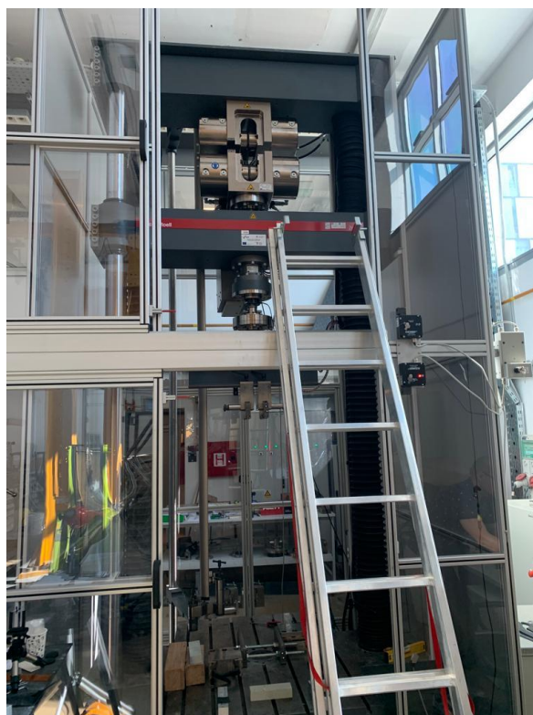
Slika 6.33. Kidalica Zwick/Roell Z600, radni prostor
