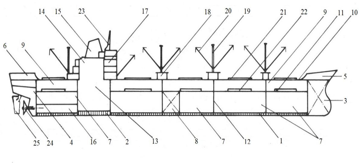
Slika 2.1. Osnovni dijelovi broda za prijevoz općeg tereta
