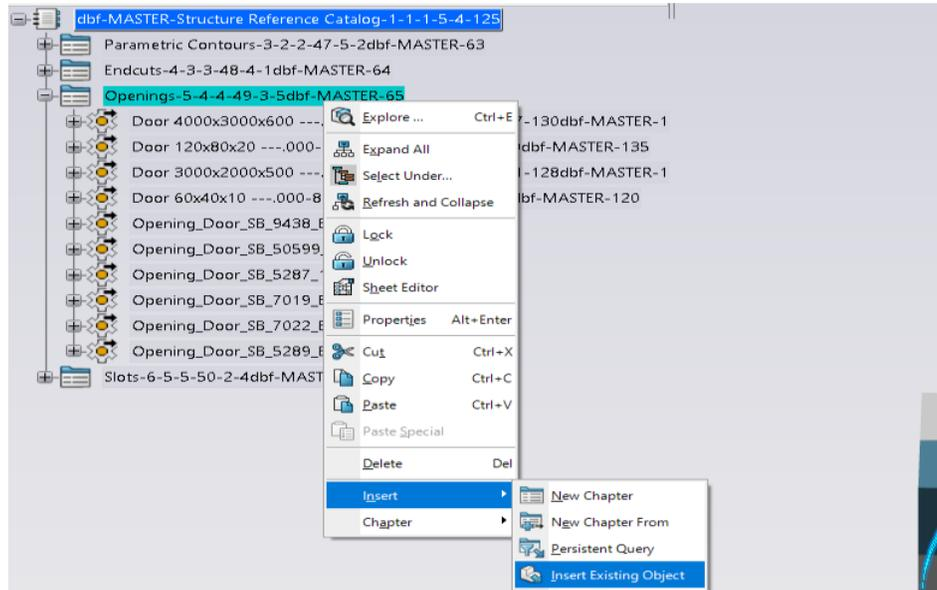
Slika 7.9. Dodavanje otvora unutar pod kataloga *Openings*
