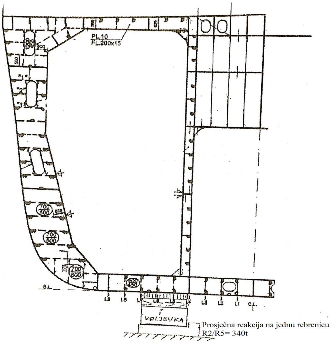
Slika 6.3 Karakteristična rebrenica iznad koljevke na poziciji u vrijanti A [4]
