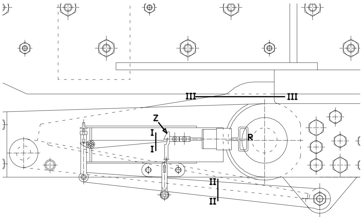
Slika 3.5 Zaporni mehanizam [4]
