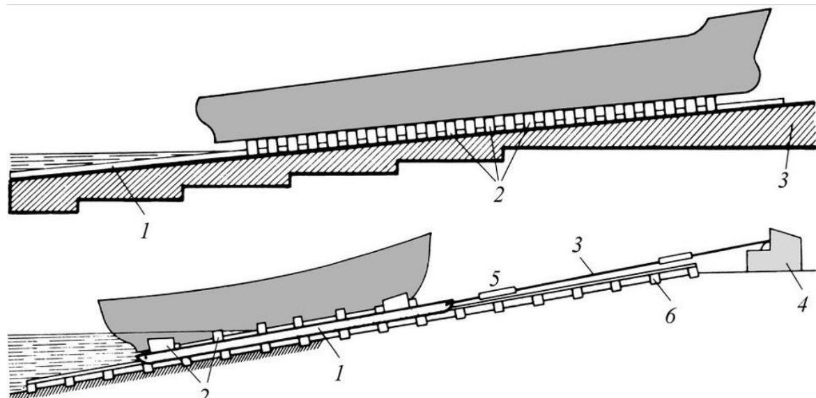
Slika 3.1 Uzdužni navoz: 1)klizna staza, 2)potklada, 3)radna površina (gore); izvlačenje broda na navoz: 1)saonice, 2)koljevka, 3)uže, 4)vitlo, 5)graničnik, 6)poprečni drveni pragovi (dolje) [6]
