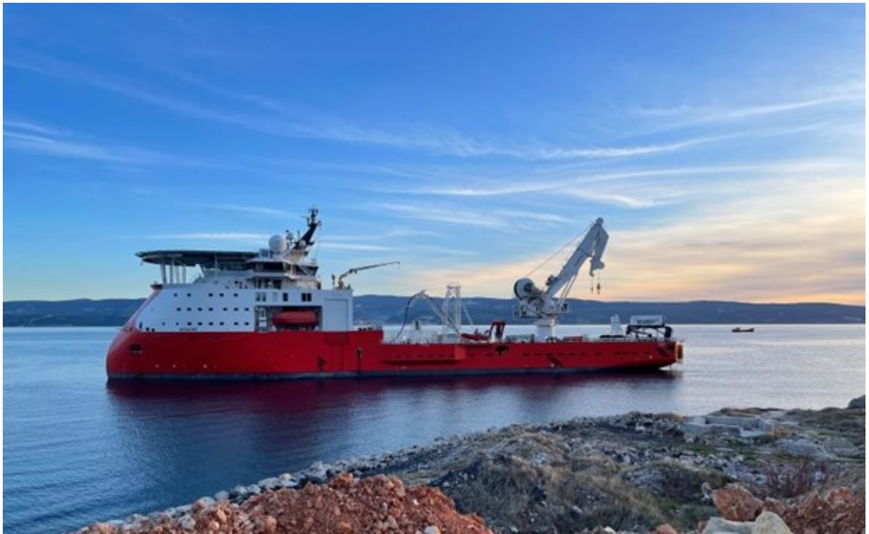
Slika 4.9. Kabelopolagač M/V Ariadne [20]
