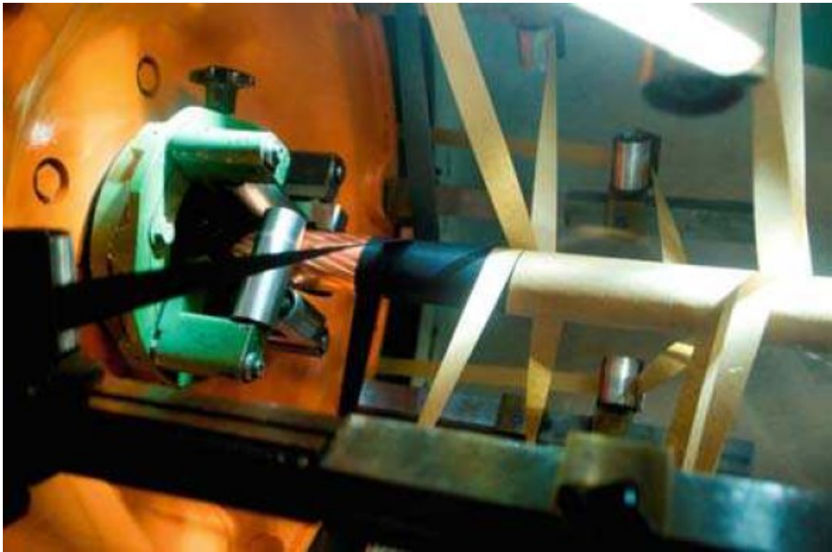
Slika 4.3. Nanošenje ugljen-crne papirnate trake i izolacijskog papira na bakreni vodič (podaci ustupljeni od strane tvrtke ABB, Švedska) [13]
