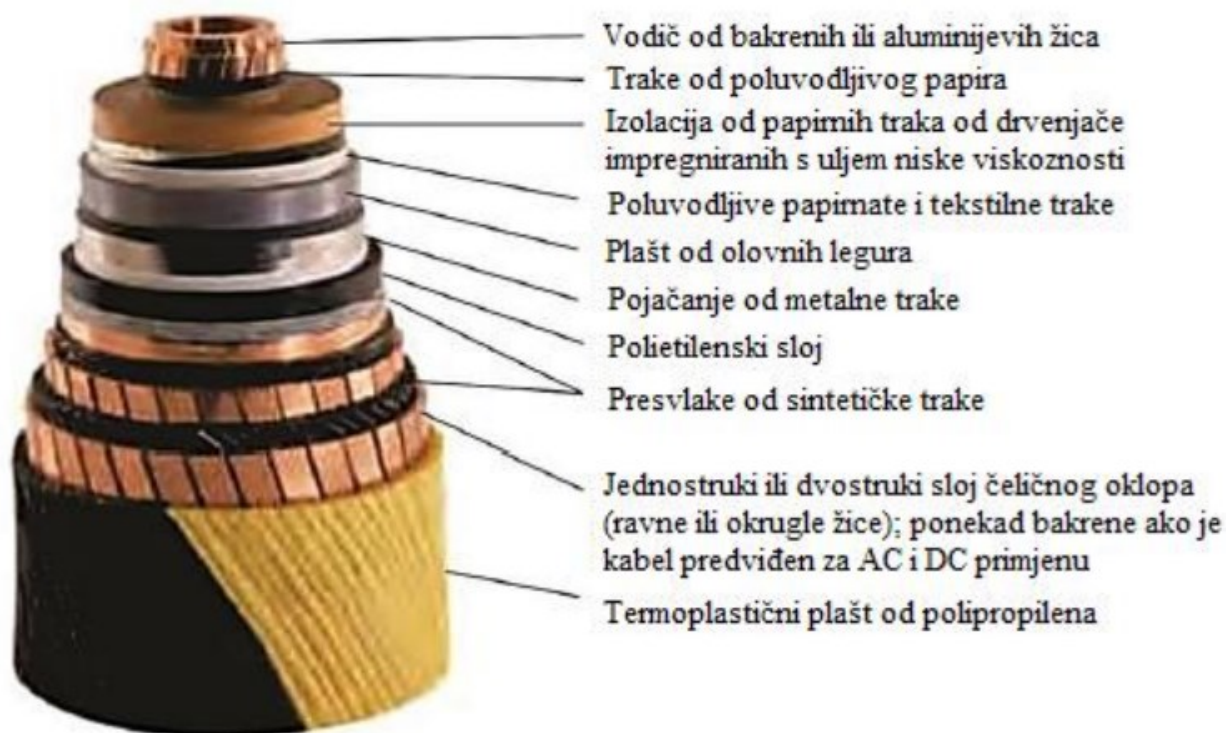
Slika 3.9. SCOF HVDC kabel tipične težine 40 do 80 kg/m, promjera 110 mm do 160 mm [12]
